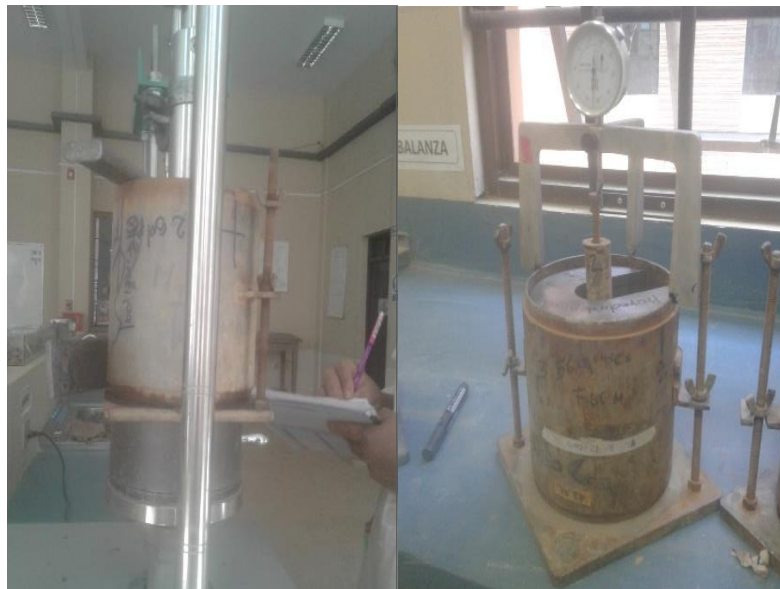
Figura 42: Rotura de la probeta en la prensa y lectura de la expansión.
