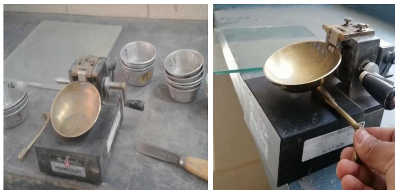
Figura 23: Equipo y materiales para el ensayo de límites de Atterberg.
