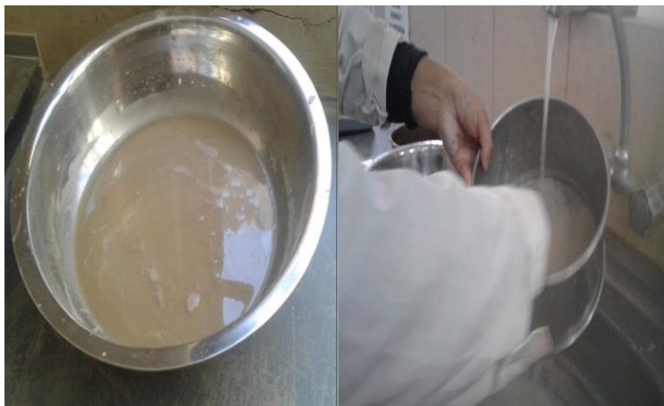
Figura 26: Lavado del suelo por el tamiz N° 200.
