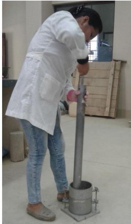
Figura 32: Ensayo de compactación del suelo.
