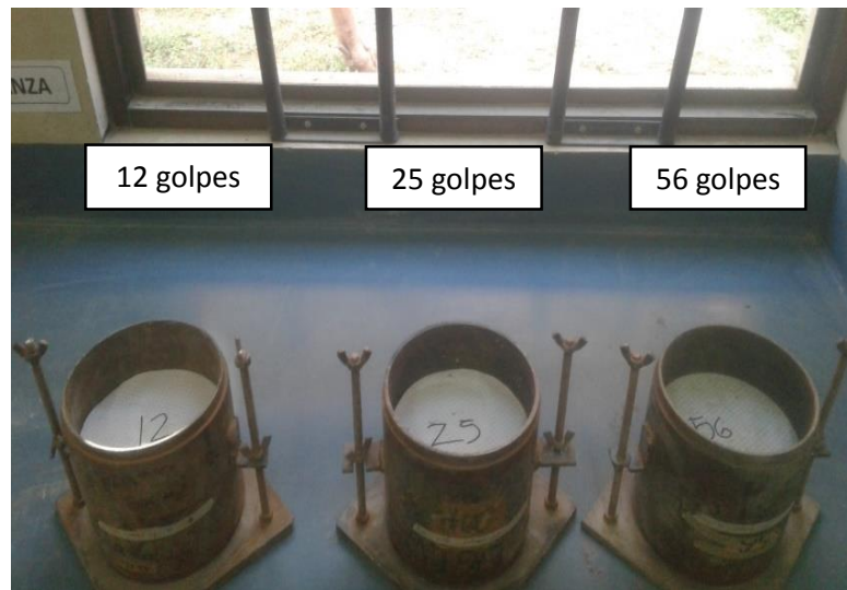
Figura 41: Moldes de CBR suelo - aluvial con diferentes golpes de energías.
