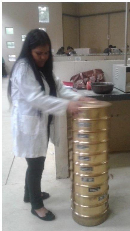
Figura 37: Tamizado de la muestra suelo - aluvial.
