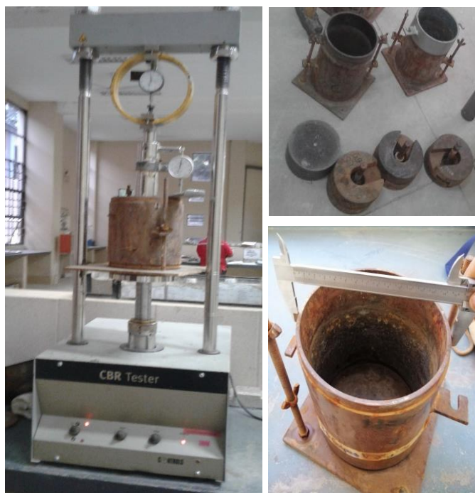
Figura 25: Equipo y materiales para el ensayo de CBR (Relación de Soporte de California).
