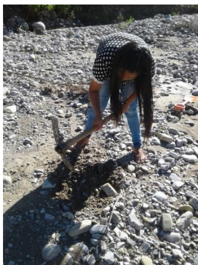
Figura 21: Extracción de la muestra (suelo aluvial).
