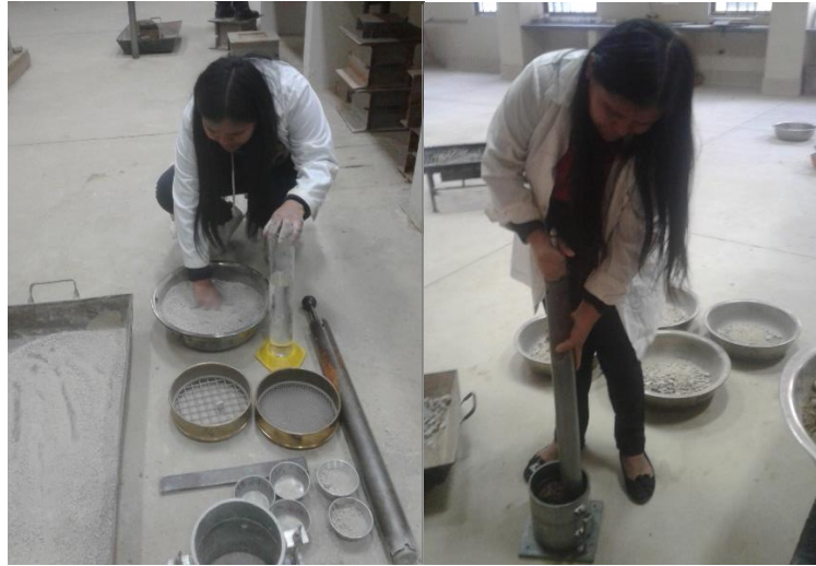
Figura 38: Combinación y compactación de la muestra suelo- aluvial.
