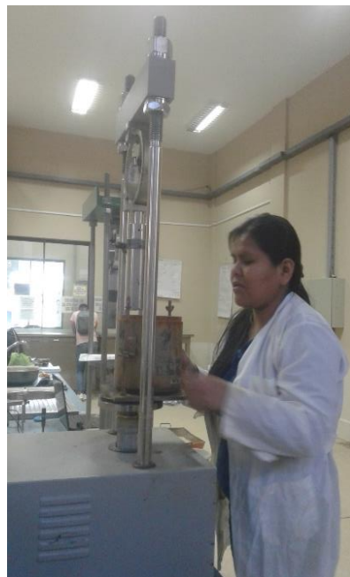
Figura 34: Determinación de la resistencia a la penetración.
