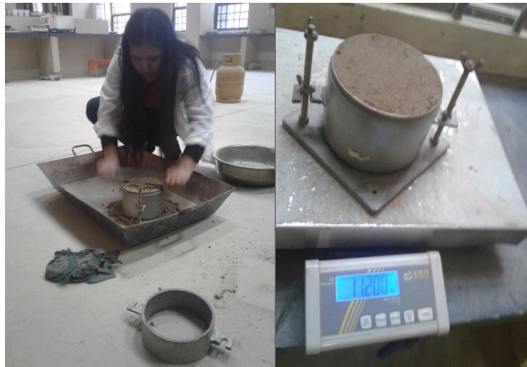
Figura 39: Enrasado y pesado de la muestra suelo – aluvial.
