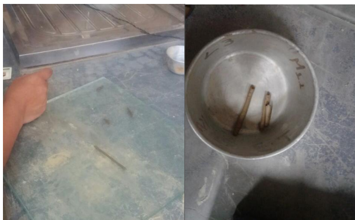
Figura 29: Determinación del límite plástico del suelo.
