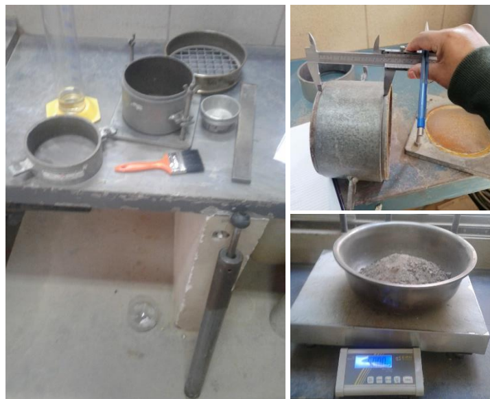
Figura 24: Equipo y materiales para el ensayo de compactación
