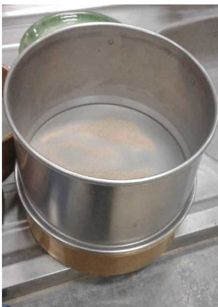
Figura 27: Tamizado del suelo después del lavado.
