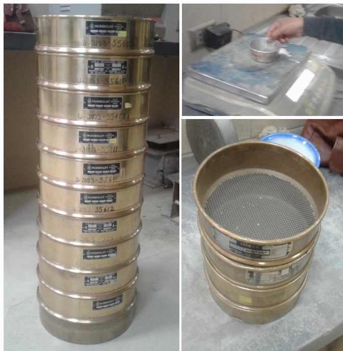
Figura 22: Equipo y materiales para el ensayo de granulometría.
