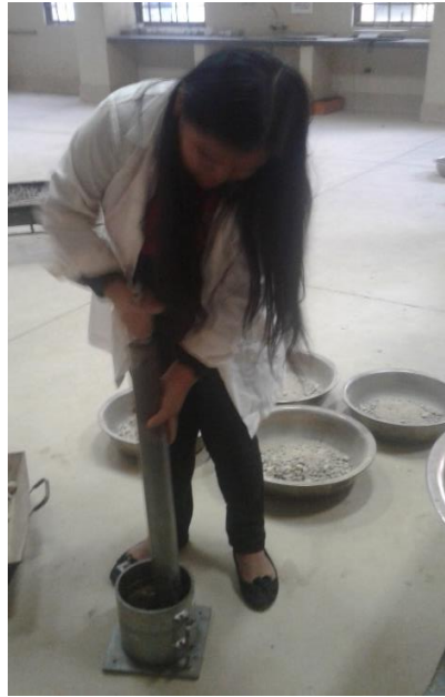
Figura 33: Compactación de moldes CBR a distintos golpes.
