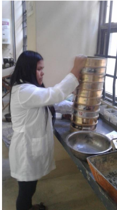
Figura 35: Tamizado del suelo aluvial.
