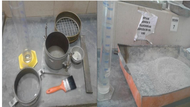
Figura 31: Materiales y tamizado del suelo por el tamiz N° 4.
