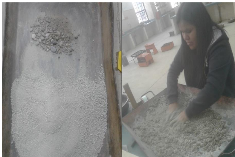
Figura 40: Preparado y mezclado de la muestra suelo - aluvial.
