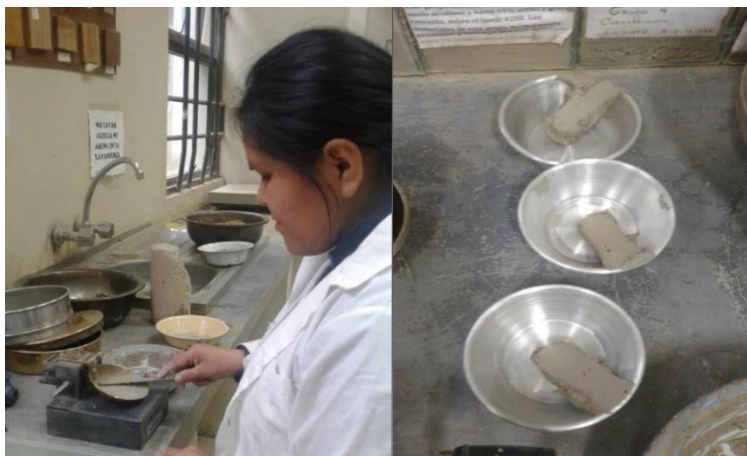
Figura 28: Determinación del límite líquido del suelo.
