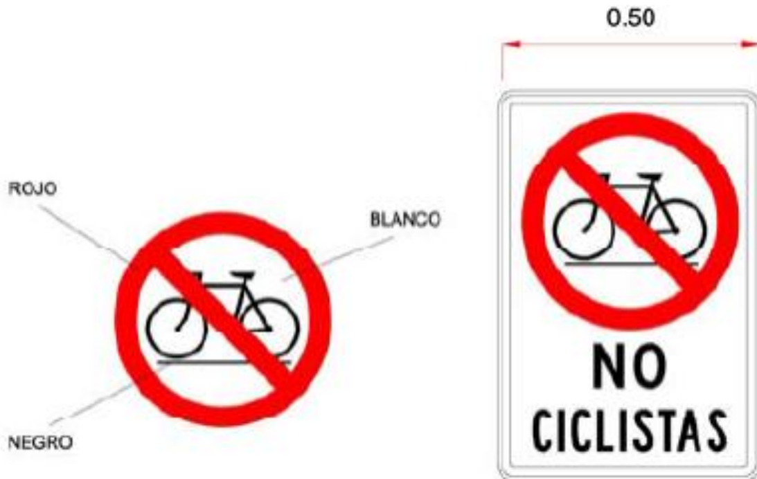
Figura 2. 35: Señal reguladora r-22
