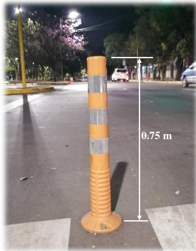
Gráfico 3. 31: Postes delineadores flexibles viales de poliuretano.
