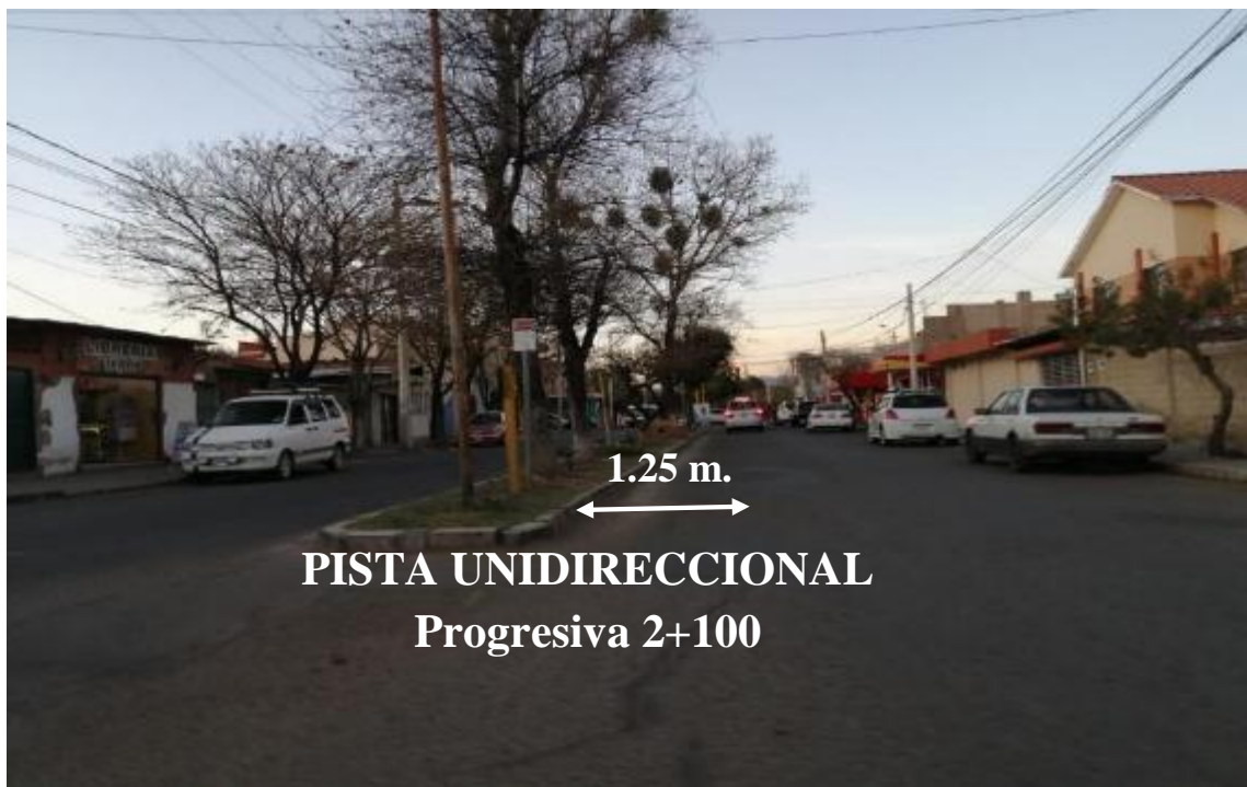
Gráfico 3. 28: Ancho de pista tramo 7, progresiva 2+100 (av. Horacio Aramayo)
