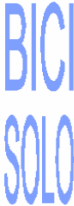
Figura 2. 52: Marcas en el pavimento - solo bici
