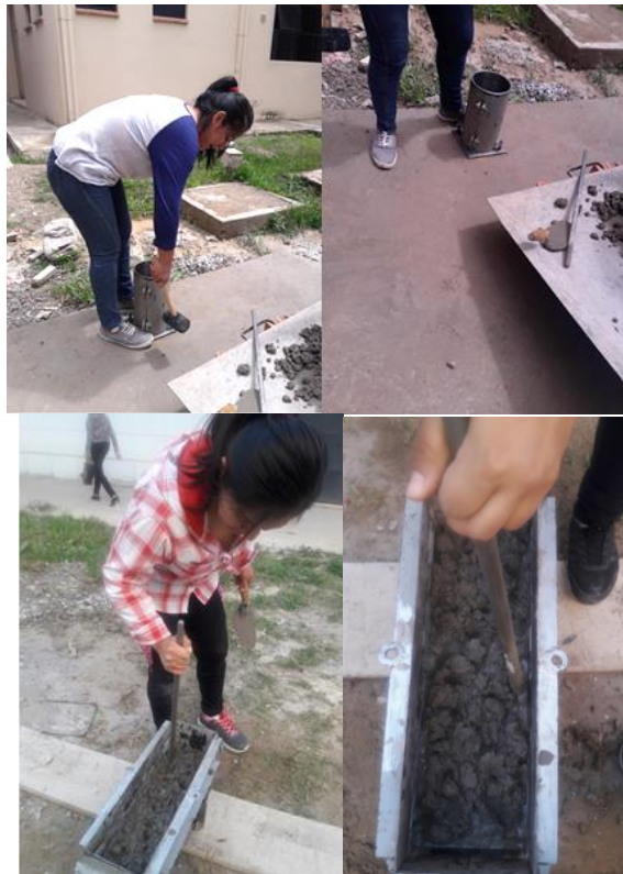
Figura 3.52. Vaciado del hormigón en los moldes
