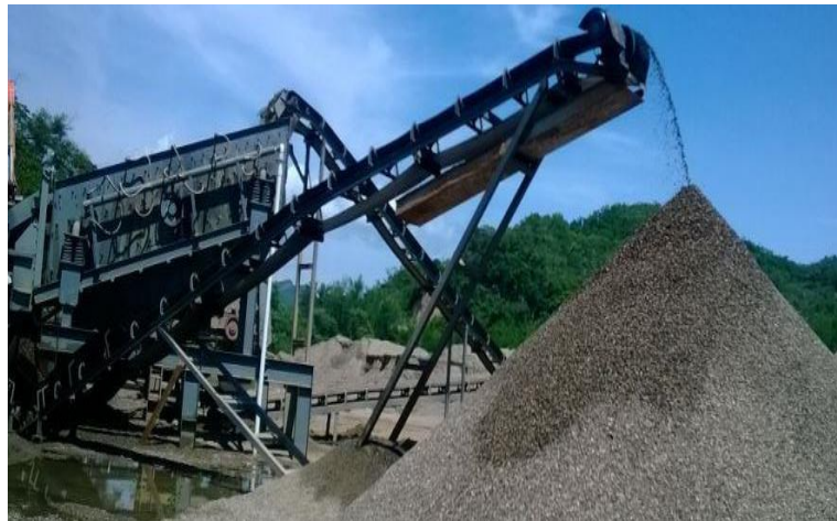
Figura 2.6. Chancadora de agregados
