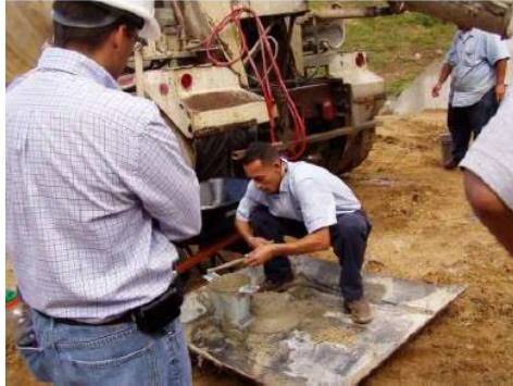
Figura 2.48. Personal de la obra realizando el ensayo del cono de Abrams
