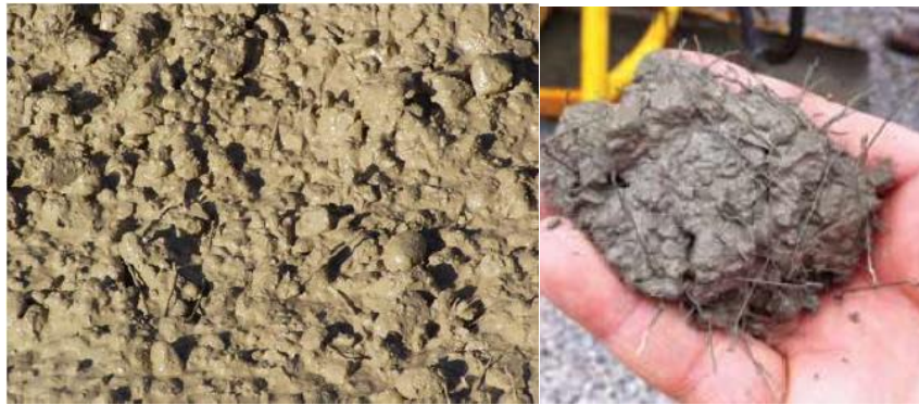
Figura 2.49. Mezcla de hormigón fresco con fibras
