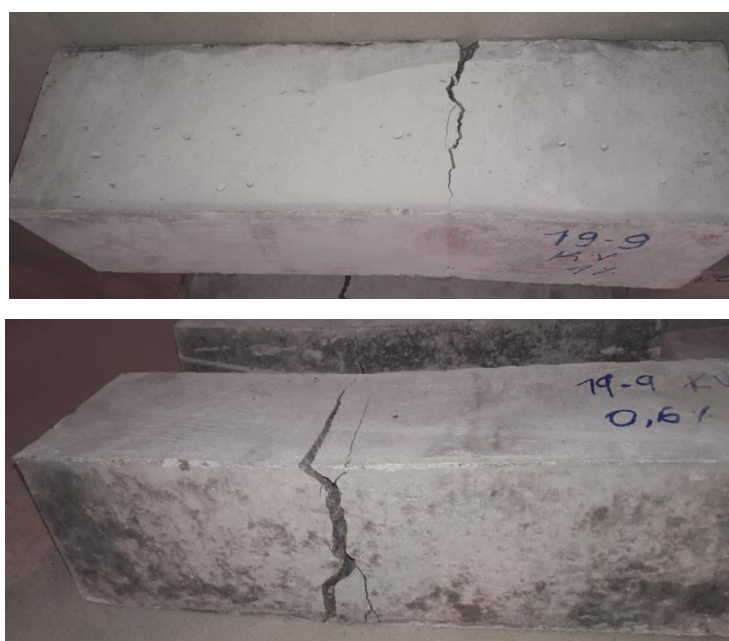
Figura 3.61. Resultado de las pruebas de rotura a flexo-tracción
