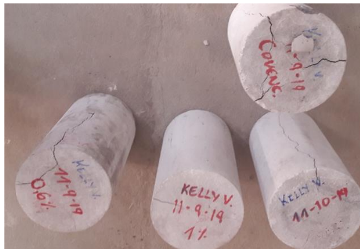
Figura 3.58. Resultado de las pruebas de rotura a compresión
