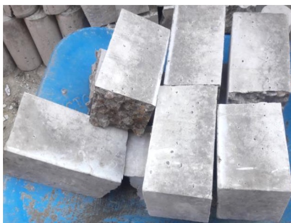
Figura 3.59. Resultado de las pruebas de rotura a flexo-tracción
