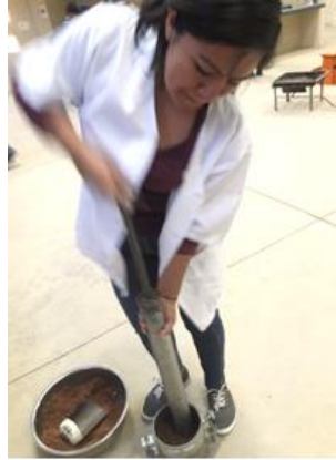
Figura 3.19. Compactación con el próctor de suelo saturado
