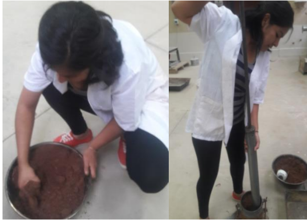
Figura 3.22. Saturación del suelo y compactación con martillo T-180
