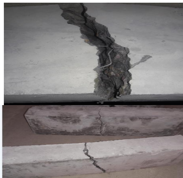
Figura 3.62. Resultado de las pruebas de rotura a flexo-tracción
