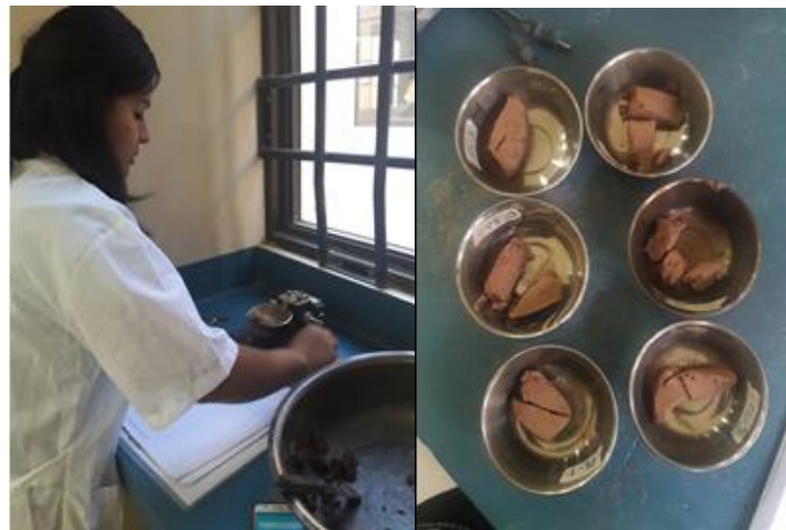
Figura 3.15. Material obtenido del ensayo a diferentes números de golpes
