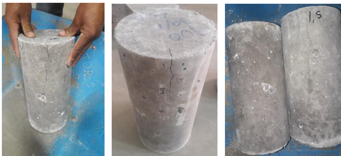
Figura 3.57. Resultado de las pruebas de rotura a compresión
