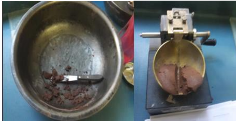
Figura 3.14. Límite líquido con el aparato de Casa Grande
