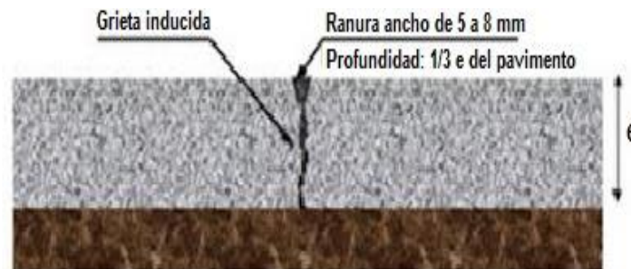
Figura 2.12. Detallamiento de junta transversal de contracción
