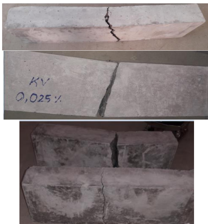
Figura 3.60. Resultado de las pruebas de rotura a flexo-tracción
