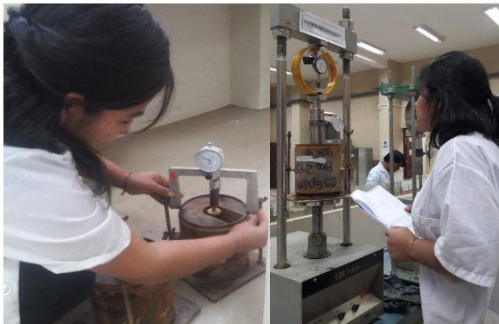
Figura 3.23. Lectura de expansión del suelo y lectura la carga aplicada sobre área
