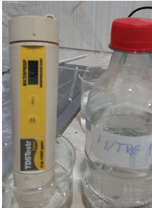
figura 32. Medición de Solidos Totales Disueltos (TDS) "Entre Rios"
