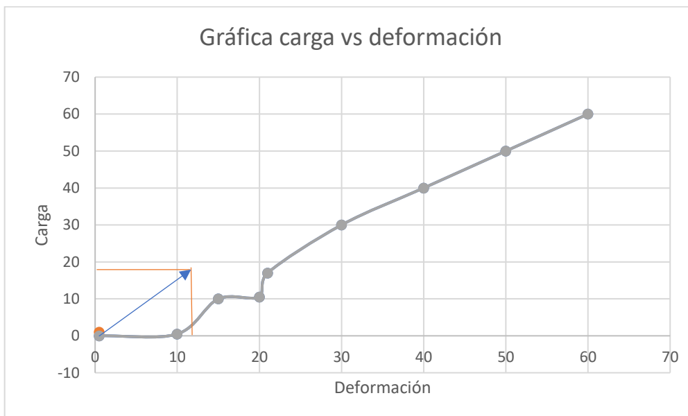
Gráfica N°15: Gráfica carga vs deformación prueba 3
