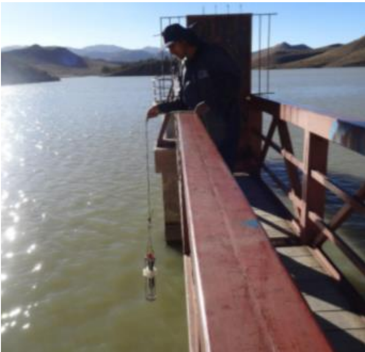
Figura 3. 7 Medición de la velocidad de sonido en el embalse “El Tranque”
