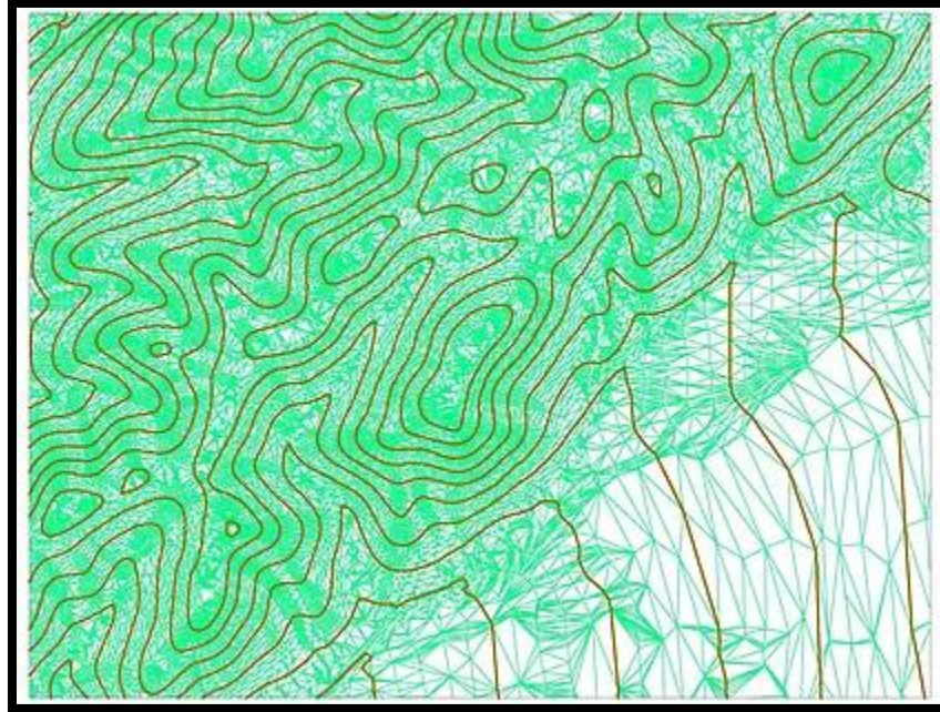
Figura 2. 4 MDT en formato TIN con curvas de nivel en formato vectorial
