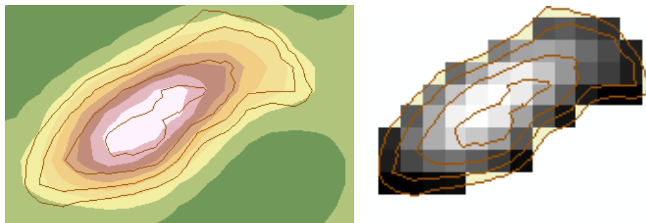
Figura 3. 14 Conversión de MDE a ráster para el cálculo de volumen
