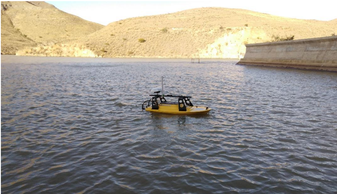
Figura 3. 6 Levantamiento Batimétrico embalse “El Tranque”
