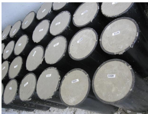
Figura 8 Especímenes cilíndricos de concreto
