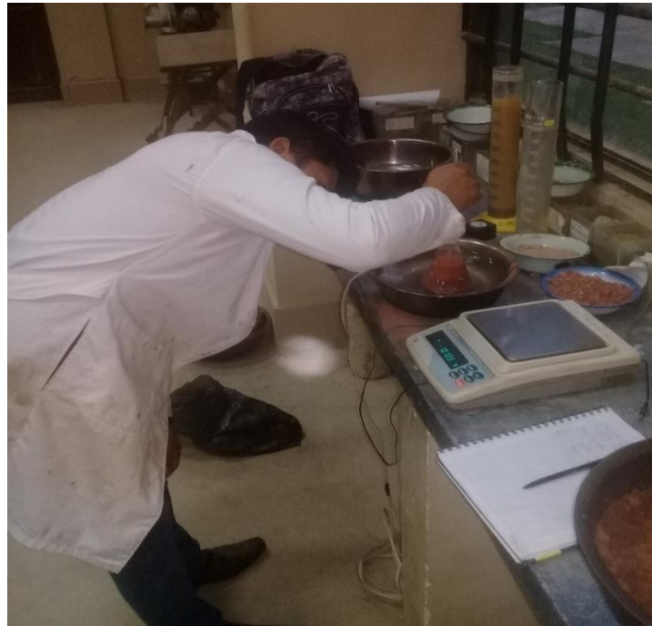
Figura Nro. 45 Controlando la temperatura para determinar el peso específico
