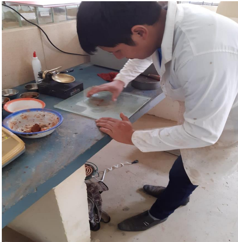
Figura Nro. 44 Ensayo del limite plastico
