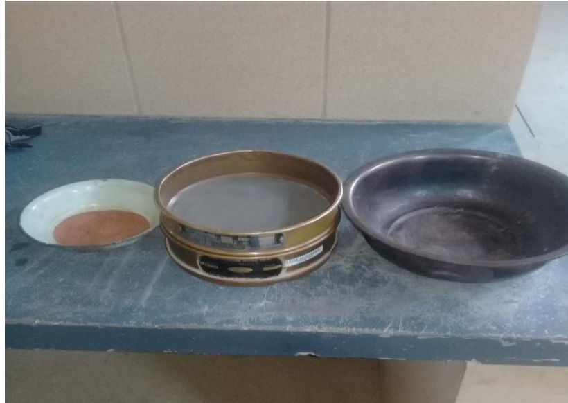
Figura Nro. 42 Material para el ensayo de granulometria
