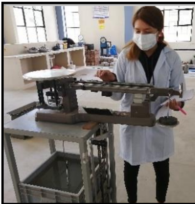
Figura N° 17. Equilibrando la balanza con las pesas para obtener el peso sumergido.
