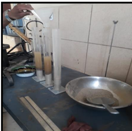
Figura N° 31. Agitando la probeta con el defloculante.
