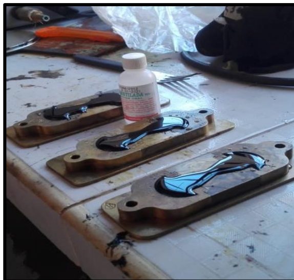
Figura N° 50. Colocar el cemento asfáltico en los moldes dejando por 30 minutos secando.
