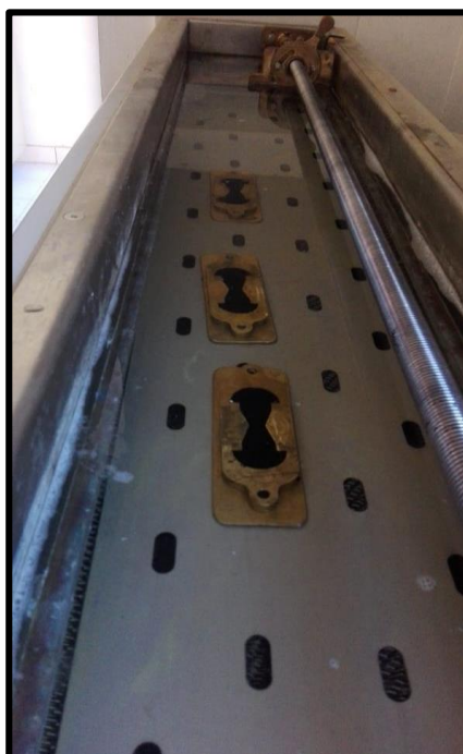
Figura N° 51. Enrasar y posteriormente dejarlo en el agua por 30 minutos.
