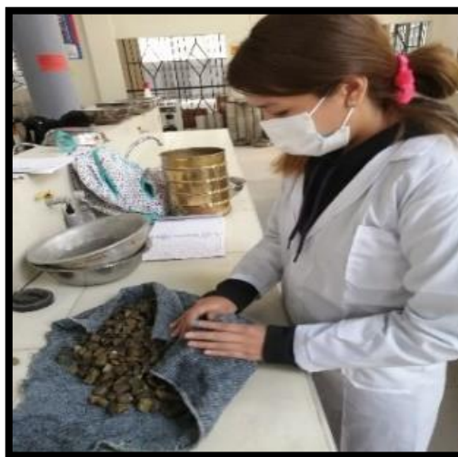
Figura N° 14. Secado la muestra saturada.
