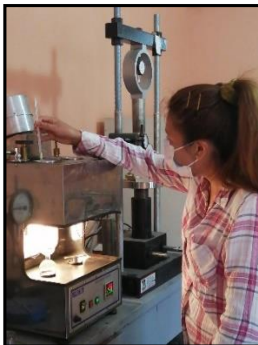
Figura N° 39. Controlando con el termómetro que la temperatura llegue a 50°C.
