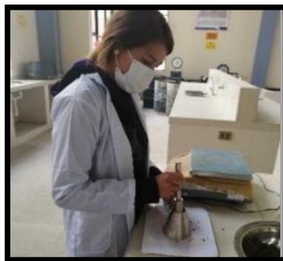
Figura N° 22. Introduciendo la muestra en el cono en 3 capas con 25 golpes y enrasando.
