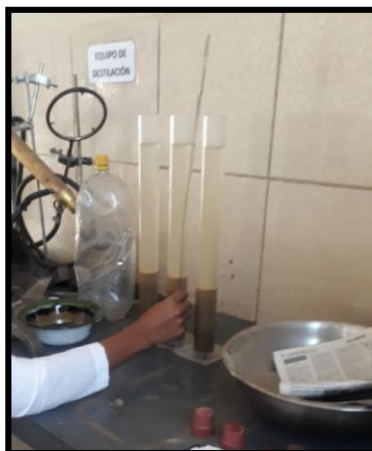
Figura N° 29. Mediante un embudo vierto la muestra de arena en las probetas hasta el límite que indica la probeta.
