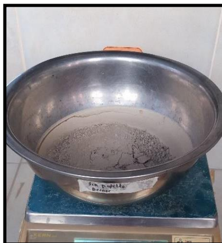
Figura N° 27. Obtención del peso seco de la muestra.
