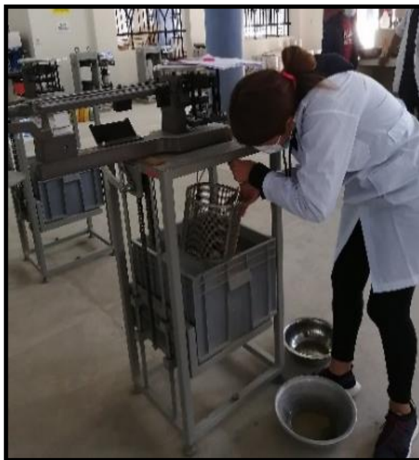
Figura N° 16. Introduciendo el canastillo con la muestra en agua
