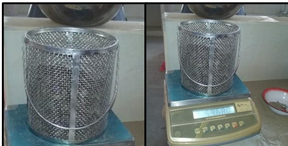
Figura N° 15. Introduciendo la muestra al canastillo para luego obtener el peso de la muestra saturada con superficie seca.
