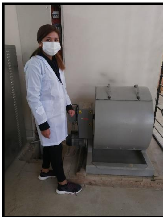
Figura N° 8. Máquina de los ángeles donde introducimos las muestras de las 2 bandejas.
