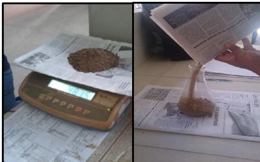
Figura N° 23. Obteniendo el peso de la muestra, vaciando la muestra en el matraz.
