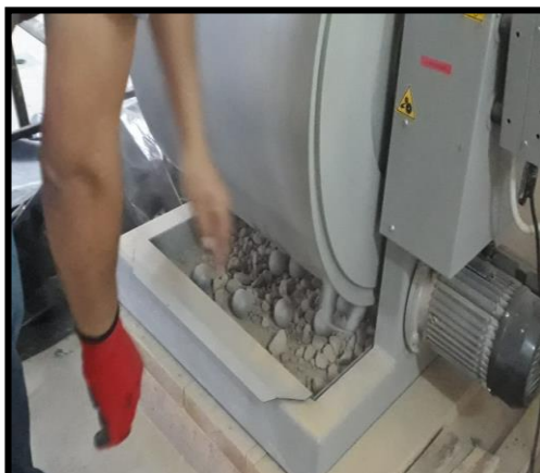
Figura N° 10. Muestra en la bandeja de la máquina de los ángeles.
