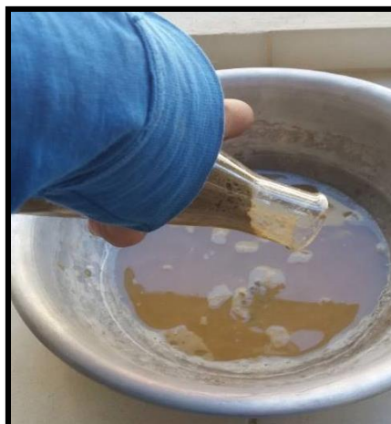
Figura N° 26. La muestra en el plato listo para meter al horno y pesarla posteriormente.
