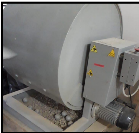
Figura N° 9. Una vez terminado las 500 revoluciones, hacemos girar la máquina para que salga la muestra desgastada.
