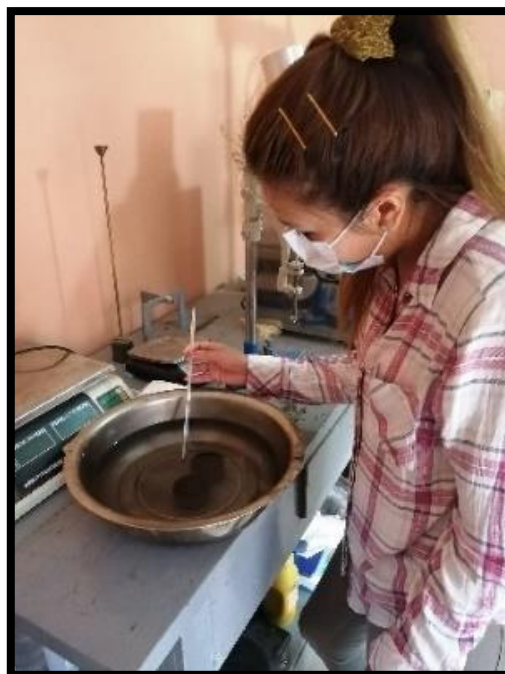
Figura N° 46. Baño de agua a 25°C.
