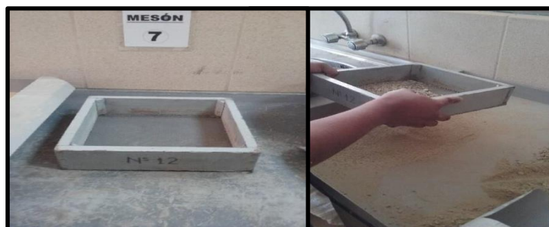
Figura N° 11. Tamizando la muestra en el tamiz N°12.
