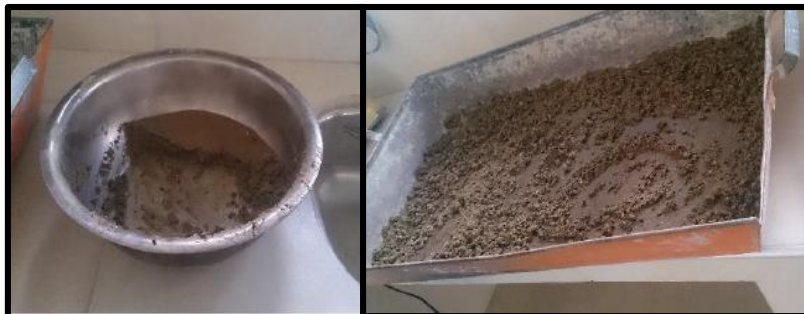
Figura N° 20. Muestra saturada y puesta en una bandeja grande.
