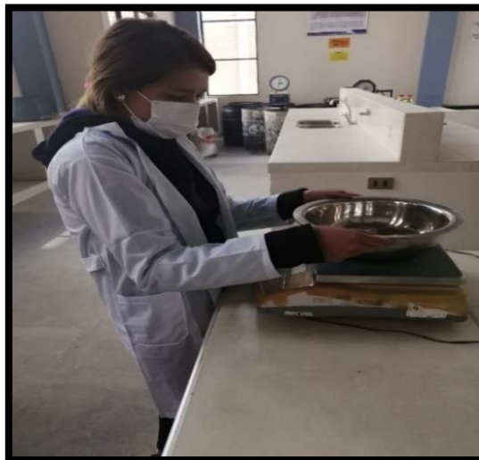
Figura N° 7. En una bandeja 2500 gr de peso retenido del tamiz 1/2" y en la otra de 3/8"
