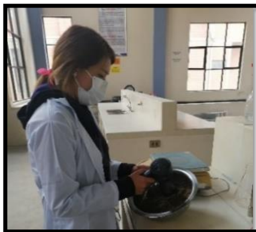
Figura N° 21. Secando la muestra de arena con secadora.
