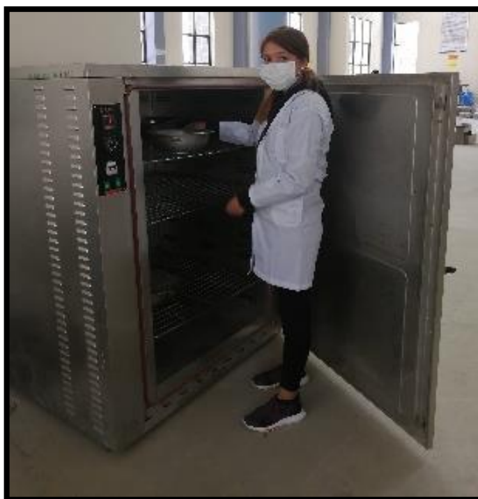
Figura N° 18. Vaciando la muestra saturada en una bandeja para luego meter al horno.
