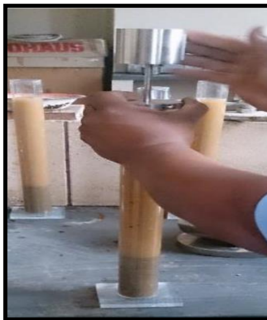
Figura N° 35. Introduciendo el pisón para compactar.
