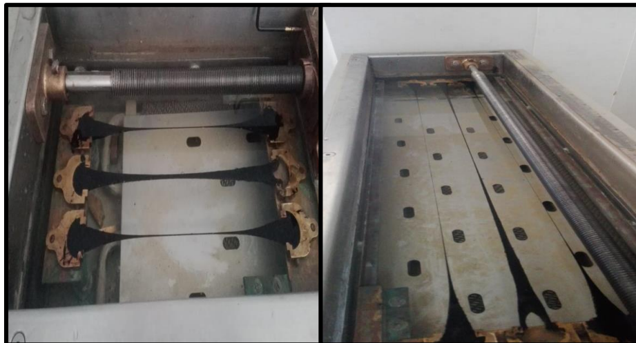
Figura N° 52. Encender el equipo y ver cuánto es la marcación en la regla cuando caiga al estirarse el ligante del cemento asfáltico.
