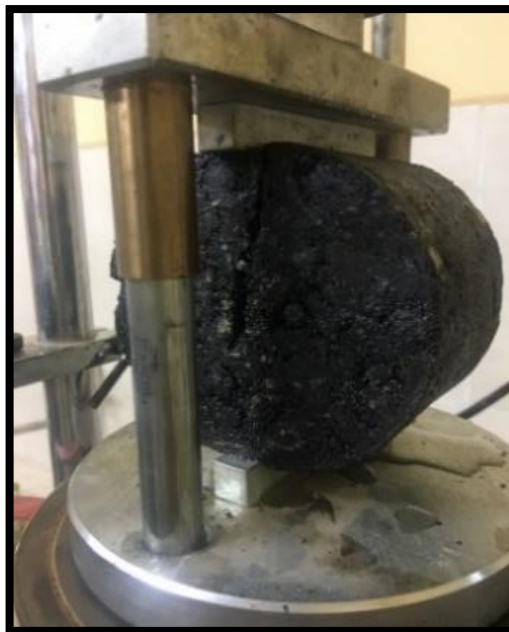
Figura N° 74. Ruptura de la briqueta.
