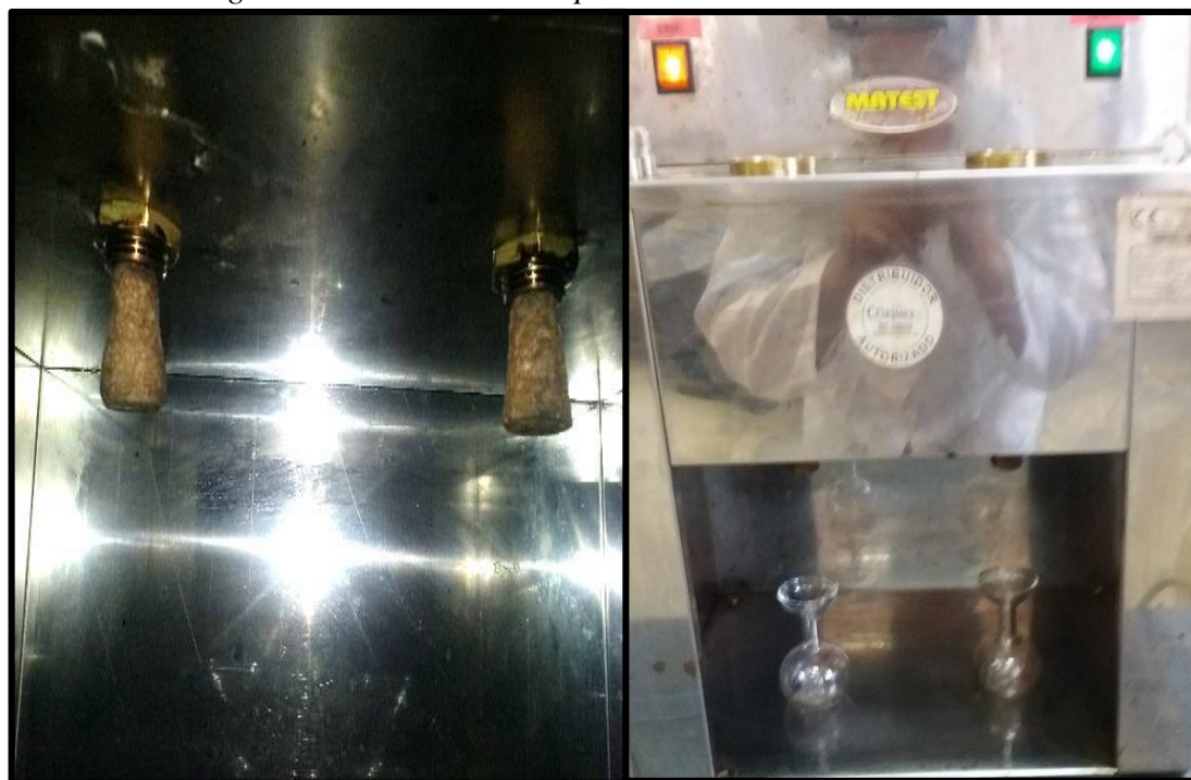
Figura N° 40. Los corchos puestos en el tubo de viscosidad.
