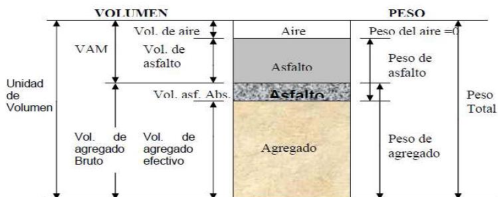
Figura N° 1. Representación de los volúmenes en una briqueta compactada de mezcla asfáltica.
