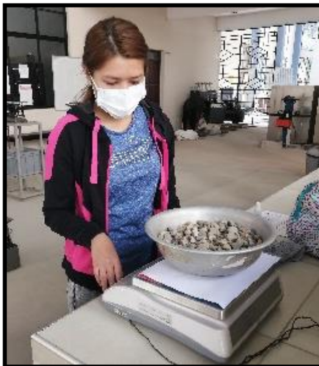
Figura N° 19. Obtención del peso seco de la muestra.
