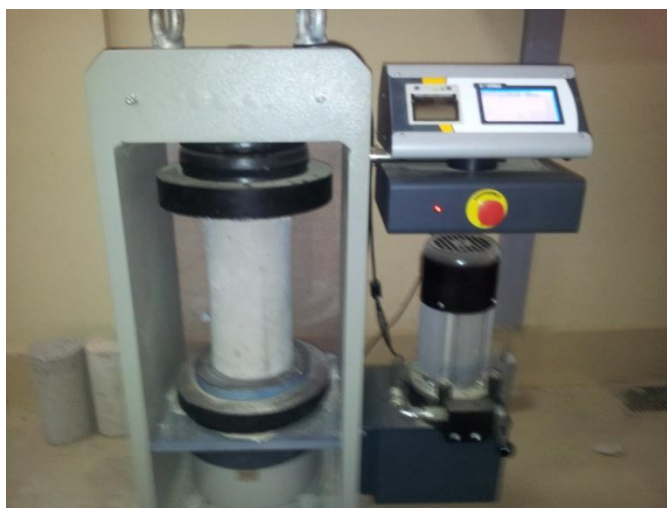
Figura 3.31 Rotura a compresión
