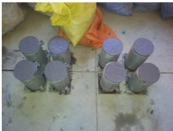
Figura 3.27 Enrazado y fraguado de las probetas de hormigón
