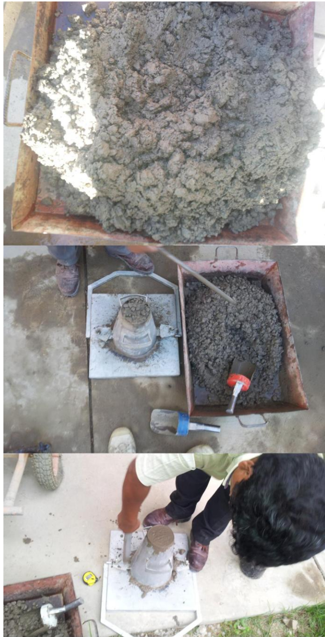
Figura 3.22 Ensayo de consistencia del hormigón FUENTE: Elaboración propia.
