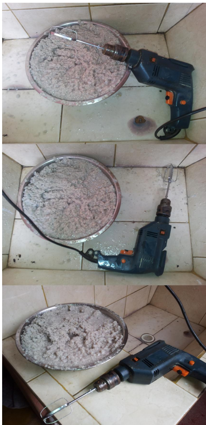
Figura 3.5 Elaboración de la pulpa de papel maché
