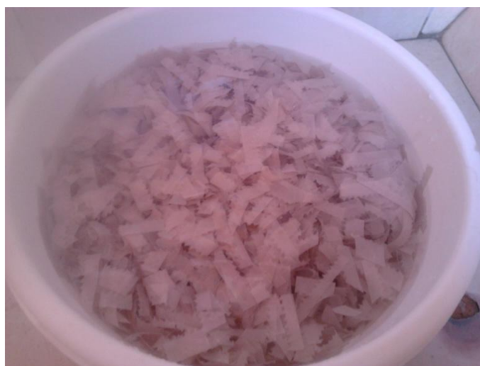
Figura 3.4 Papel periódico sometido a saturación
