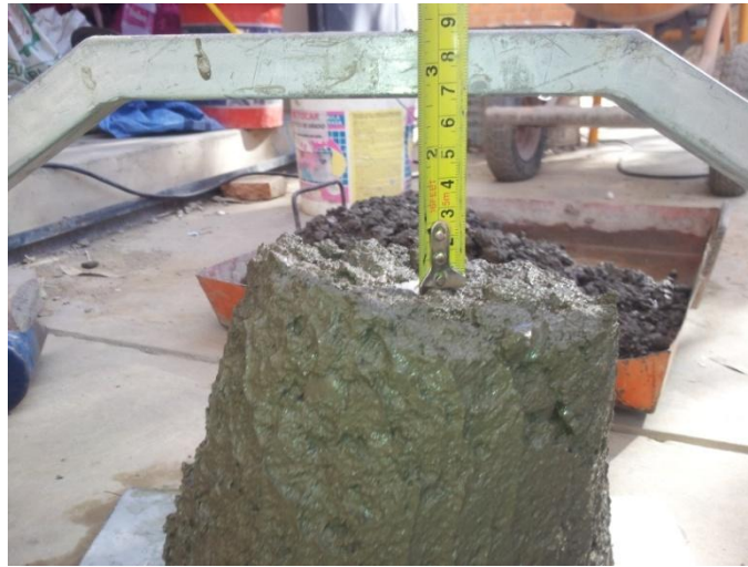
Figura 3.23 Desplazamiento de cono
