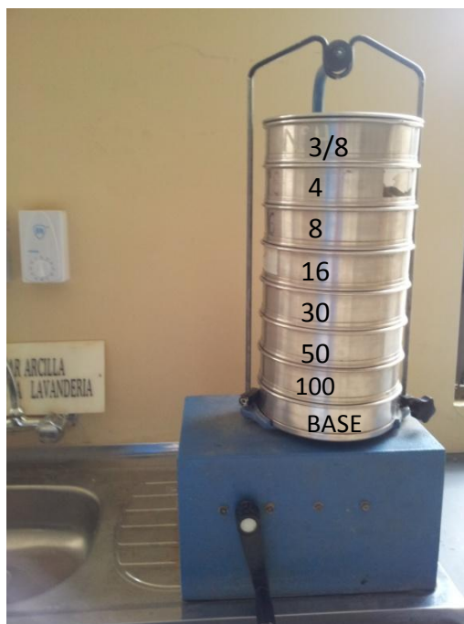
Figura 3.20 Juego de tamices o mallas estándar para hormigones
