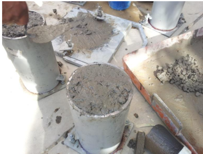
Figura 3.24 Vaciado de probetas de hormigón en moldes cilíndrico
