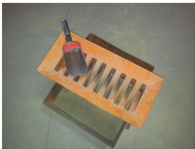
Figura 3.17 Cuarteo del agregado fino
