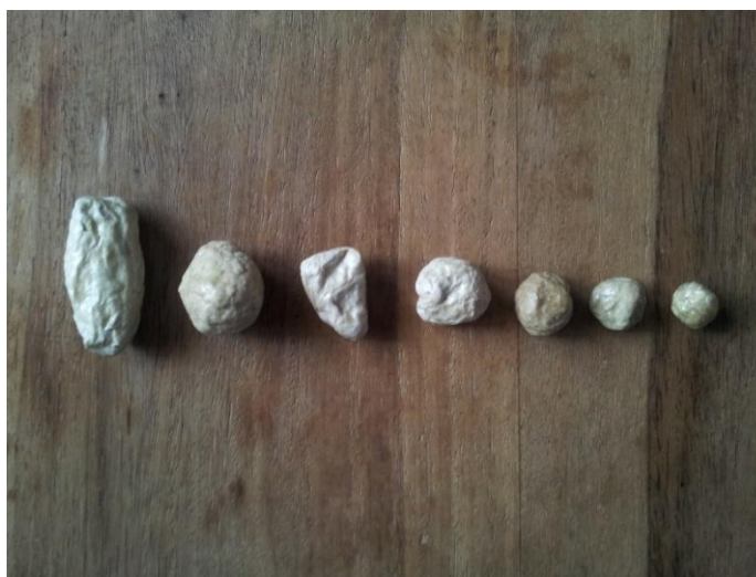
Figura 3.11 Apariencia del agregado grueso artificial ligero – Papel maché
