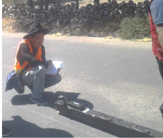
Gráfico 74 Lectura de la viga Benkelman
