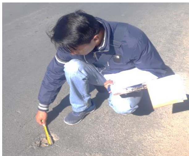
Gráfico 44 Medición de fallas superficiales
