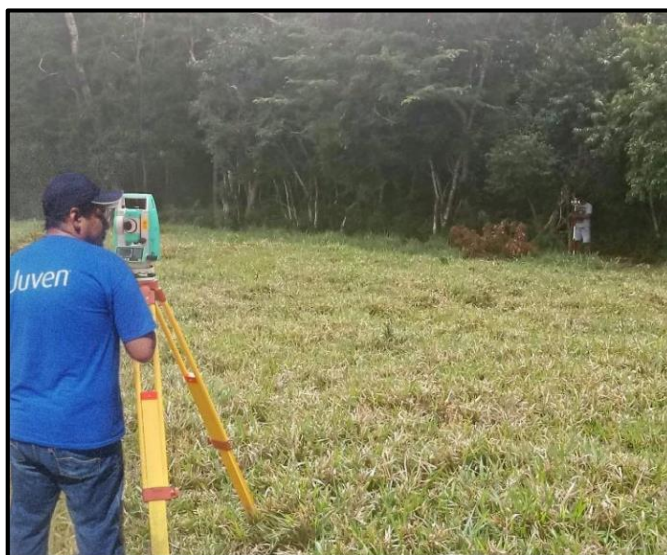
Figura 12: Levantamiento con la estación total.
