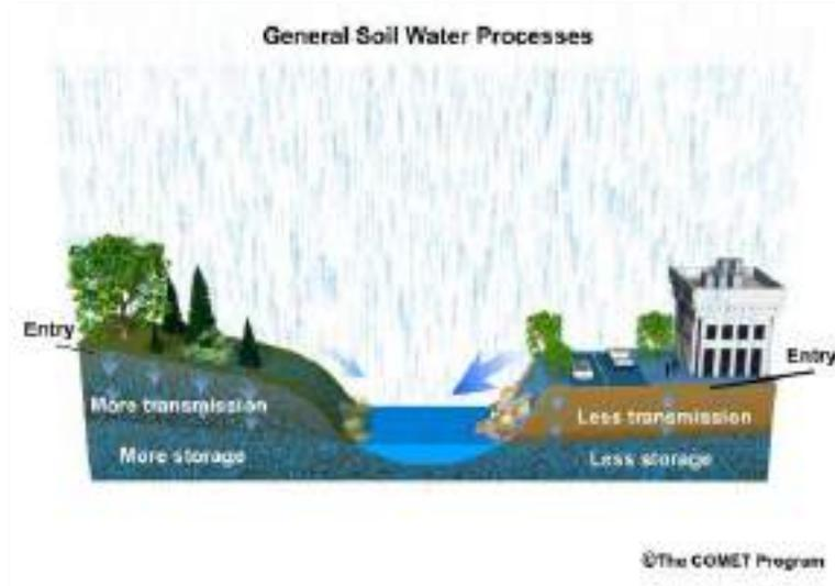
**Figura 16** Infiltración en una superficie de cobertura vegetal y una superficie urbanizada
