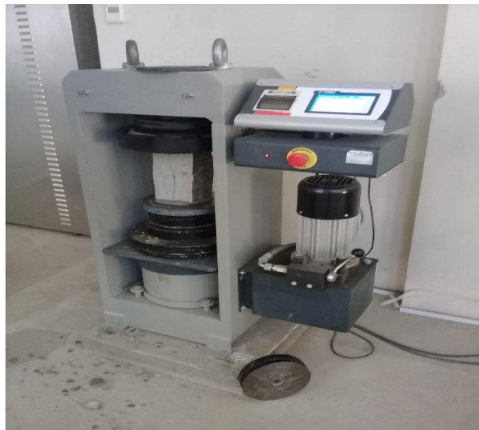
Figura 3.75 Ensayo a compresión simple
