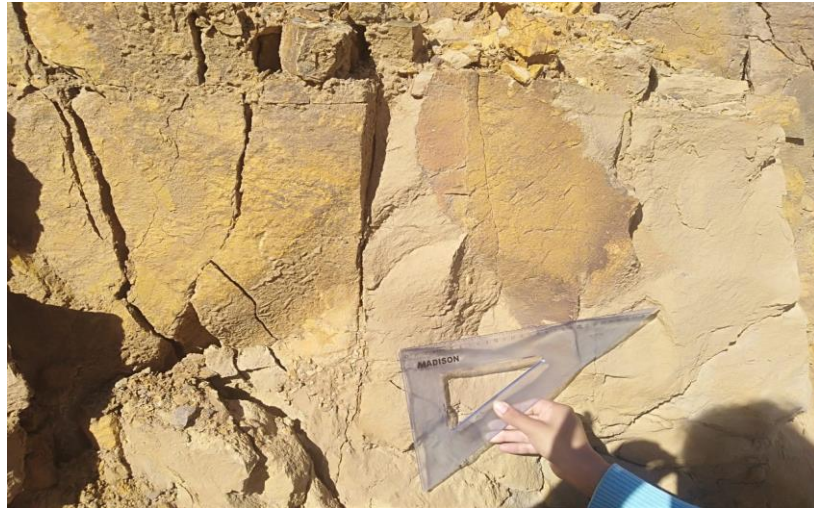
Figura 3.68 Medición de las discontinuidades
