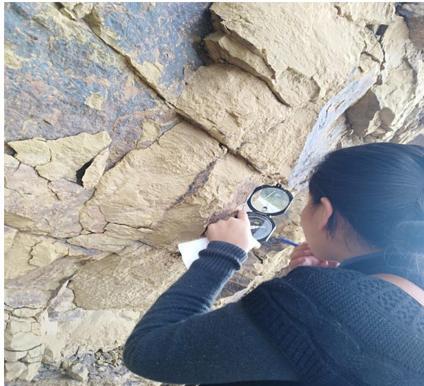
Figura 3.67 Medición del ángulo de buzamiento del talud
