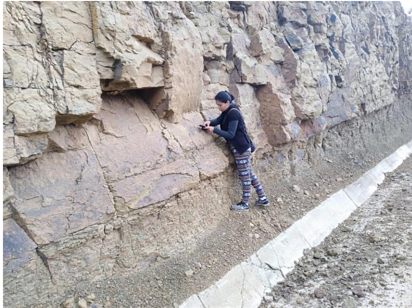
Figura 3.66 Medición del rumbo del talud
