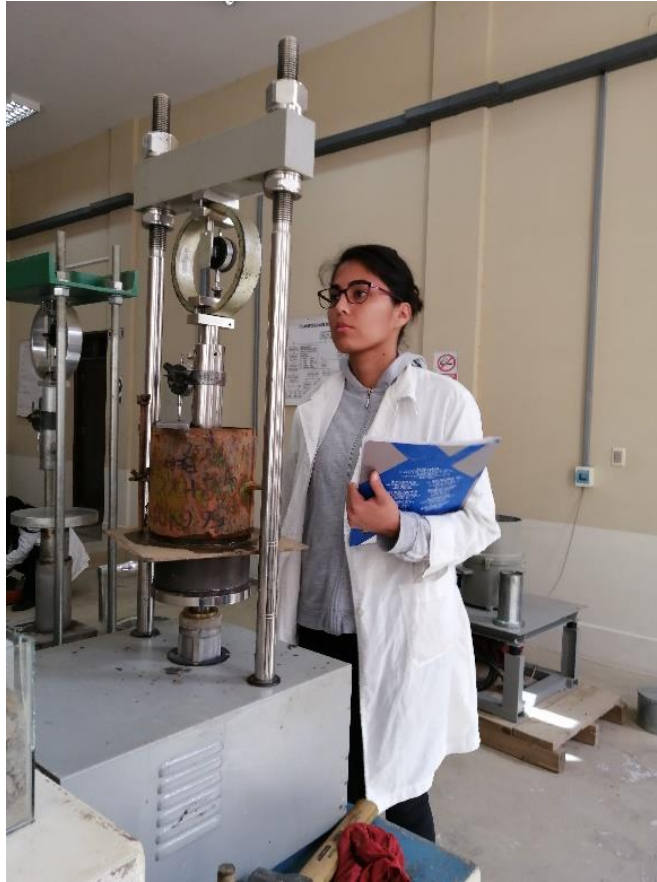
Figura 35. Lectura de las cargas de penetración
