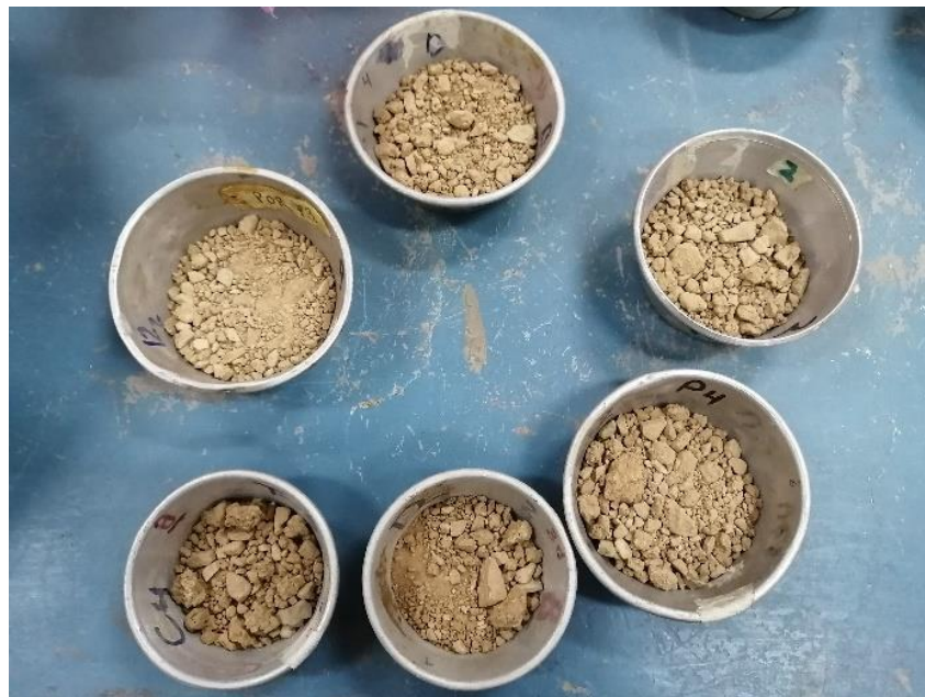
Figura 23. Ensayo de contenido de humedad
