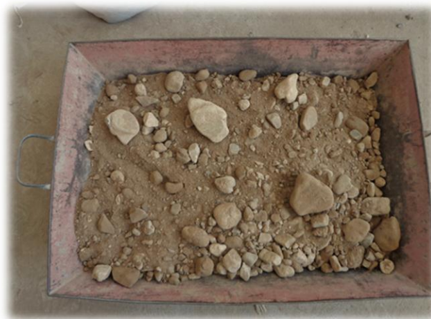
Gráfico N° 40 Muestra de suelo extraída de un camino ripiado ubicado por la Comunidad de Los Pinos
