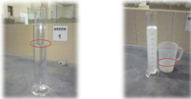
Gráfico N° 57-58 Incremento en el volumen del agua de compactado debido a la Bischofita
