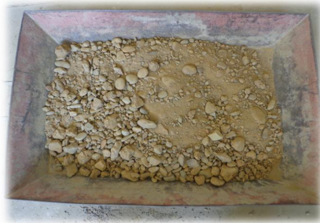
Gráfico N° 41 Muestra se suelo extraída de un camino ripiado ubicado por la Comunidad de Los Pinos
