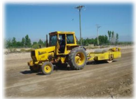
Gráfico N° 9-10 Riego de la salmuera y compactado del camino
