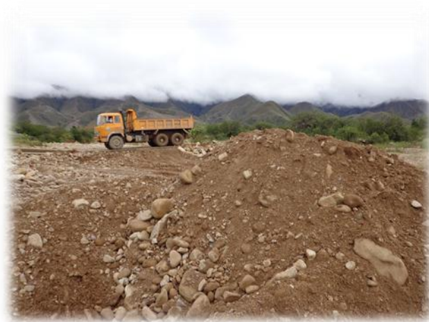
Gráfico N° 35 Banco de préstamo ubicado por la comunidad de Los Pinos (Agregado de río)
