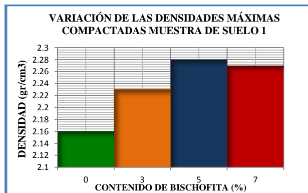
Gráfico N° 84 Variación de las densidades máximas compactadas para la muestra de Suelo 1
