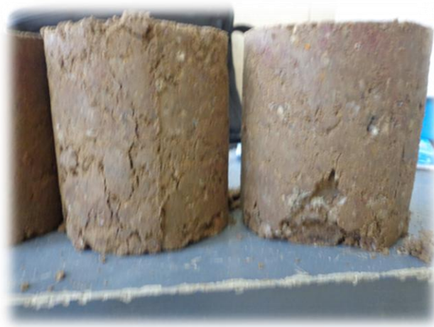
Gráfico N° 80 Fisuración de los moldes debido a la carga aplicada por la prensa
