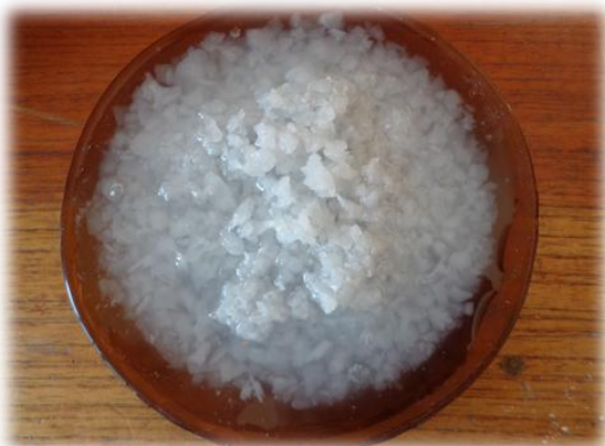
Gráfico N° 55 Humedecimiento de la Bischofita por exposición al medio ambiente
