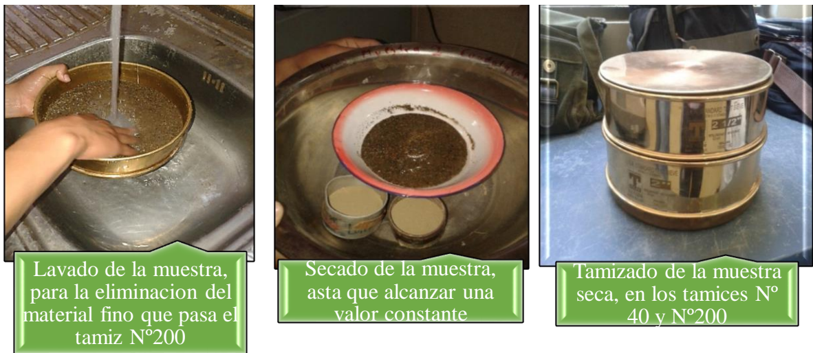
Imagen 9. Granulometría por tamizado
