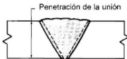
Figura 2-16 Soldadura a tope con penetración completa
