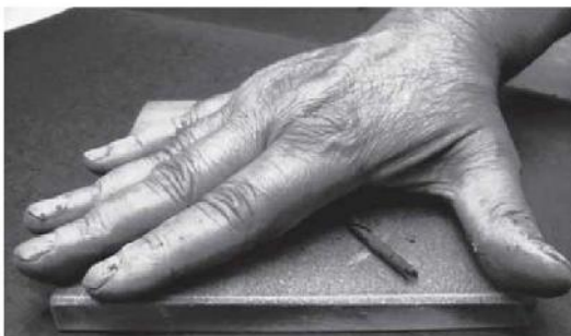
Figura 2-5 Prueba de límite plástico
