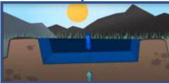
Se debe usar un recubrimiento impermeable (arcilla o geotextil) para evitar fugas o infiltraciones.
