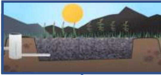
Se instalan tuberías o un sistema para la distribución y recolección del agua que pasa por la filtración mejorando su calidad, para llegar a una cámara con contacto directo para limpieza y control.
