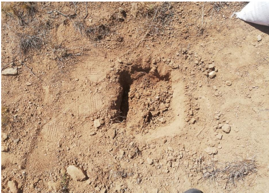
Figura 15. Extracción de muestra de suelo. (Elaboración propia)
