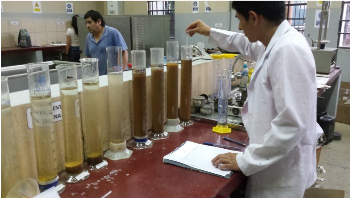
Figura 19. Determinación del (%) arena, limo y arcilla. (Elaboración propia)
