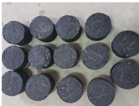
Imagen 3.8:1 Briquetas elaboradas para realizar el baño maría a 60 °C para luego colocar en el anillo Marshall
