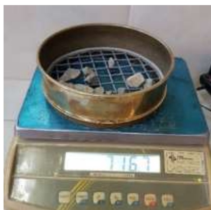
Imagen 3.6:2 Tamizado del agregado para luego pesar lo retenido en cada tamiz
