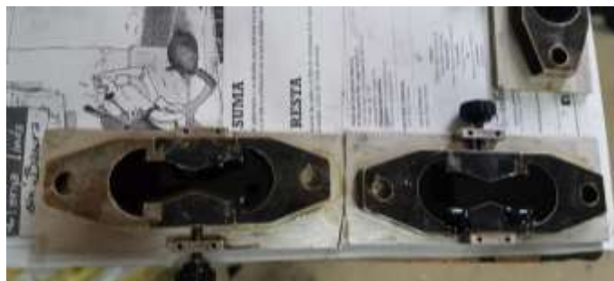
Imagen 3.6:13 Moldes llenados con asfalto para la ductilidad
