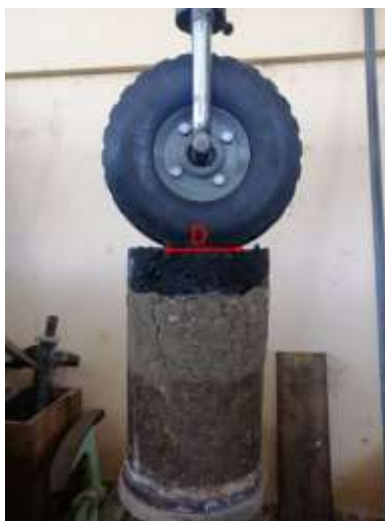
Imagen 3.10:5 Rueda pequeña de ensayo
