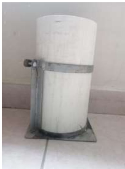
Imagen 3.10:1 Molde externo para compactación de capa subbase y base
