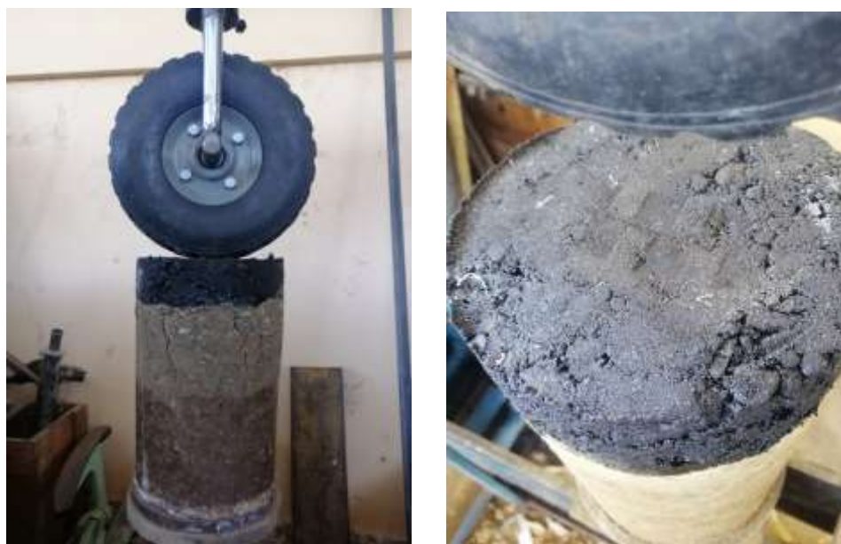
Imagen 3.10:8 Muestra después de aplicar la carga de compresión
