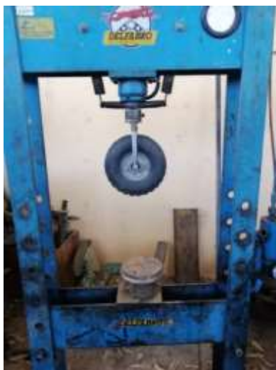
Imagen 3.10:6 Rueda utilizada para los ensayos de compresión
