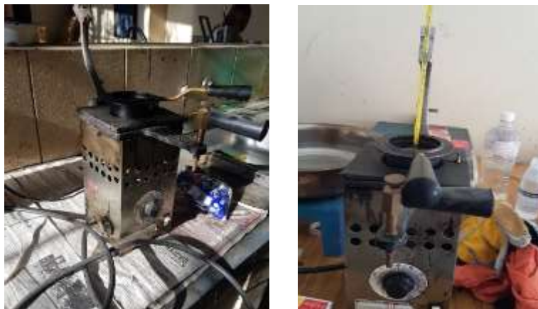
Imagen 3.6:10 Cocinilla especial para calentar el C.A. y medir temperatura de inflamación
