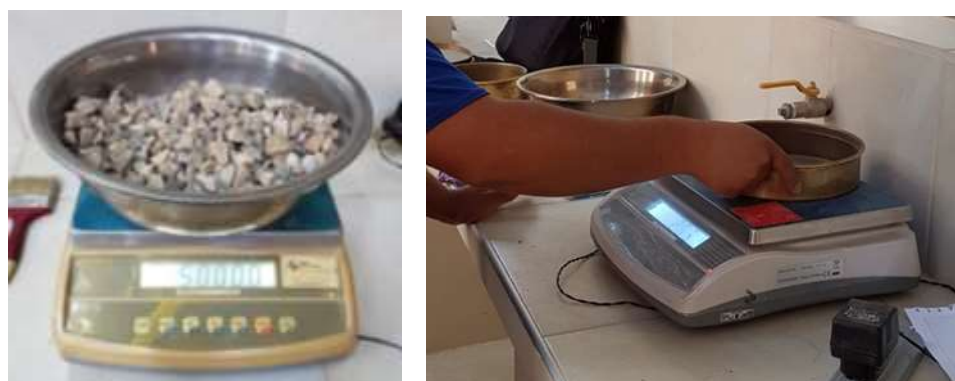
Imagen 3.6:1 Pesado del agregado más los pesos de cada tamiz
