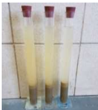
Imagen 3.6:8 Arena totalmente asentada para medir su altura
