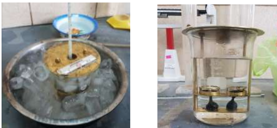
Imagen 3.6:11 Enfriamiento del cemento asfáltico para luego calentar.
