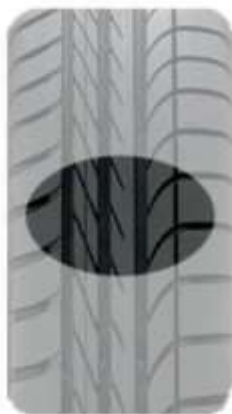
Imagen 3.10:3 Área de contacto de la rueda sobre el pavimento
