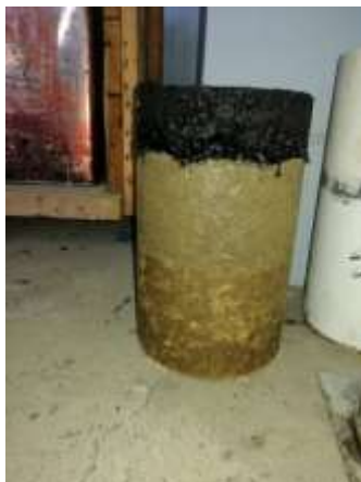
Imagen 3.10:2 Muestra compactada del paquete estructural del pavimento flexible
