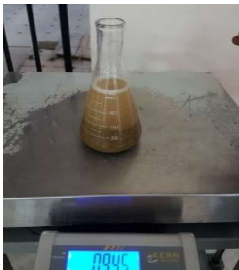
Imagen 3.6:6 Peso de la arena con humedad óptima, peso del matraz + agua + arena
