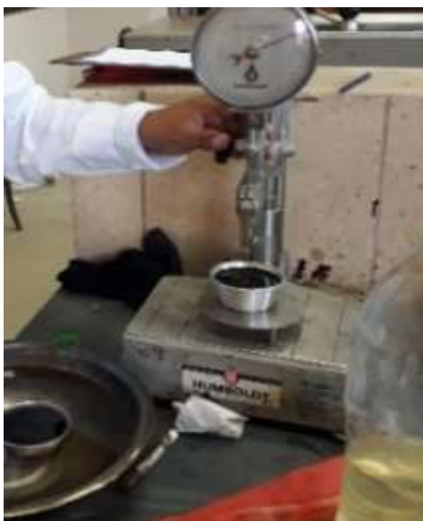
Imagen 3.6:9 Medición de la penetración
