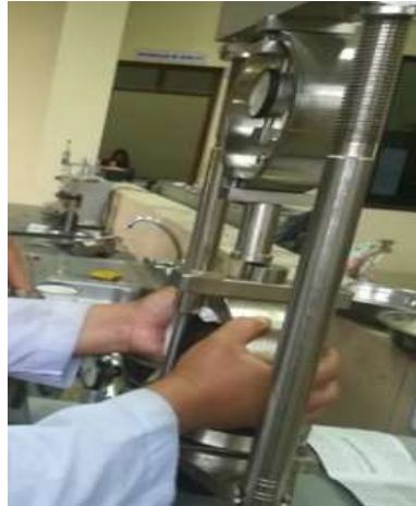
Imagen 3.8:2 Colocado de briqueta en el Marshall para lectura de la estabilidad y fluencia.
