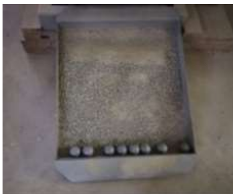
Imagen 3.6:7 Agregado grueso triturado por la máquina de los ángeles
