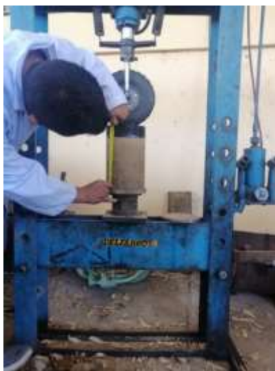
Imagen 3.10:7 Ensayo de compresión de la muestra del paquete estructural
