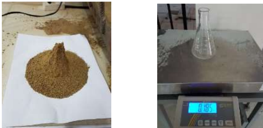
Imagen 3.6:5 Humedad óptima de la arena y peso del matraz para el ensayo
