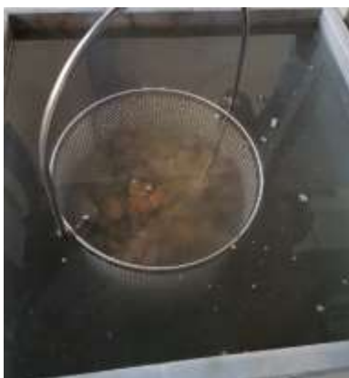
Imagen 3.6:4 Pesado del peso sumergido del agregado
