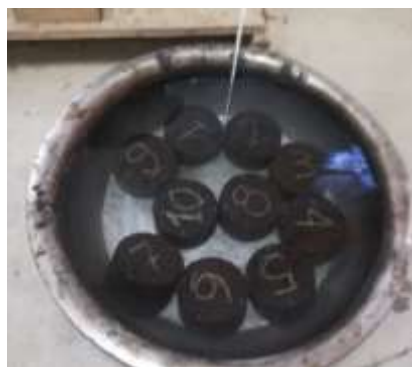
Imagen 3.8:1 Briquetas elaboradas para realizar el baño maría a 60 °C para luego colocar en el anillo Marshall
