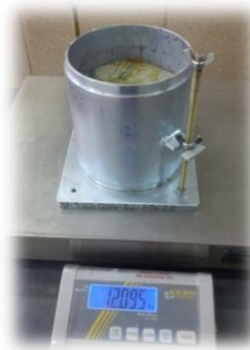
Imagen N°14, Molde más muestra compactada
