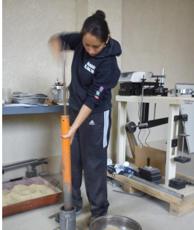
Imagen N°14, Compactación del suelo
