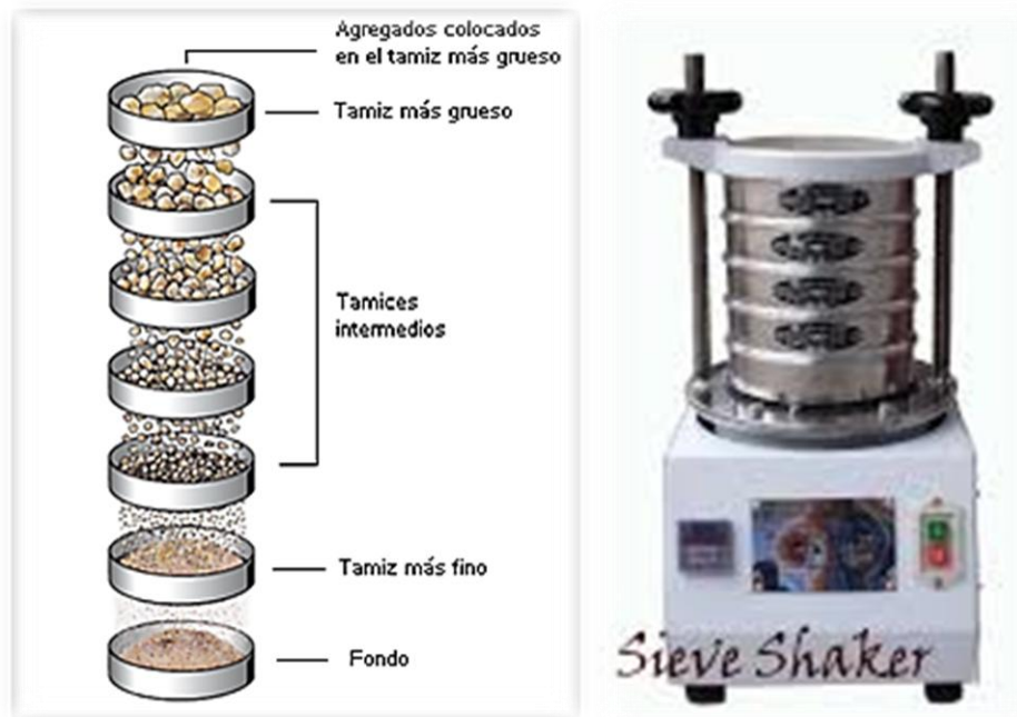
Figura N° 7 Juego de Tamices y vibrador para el análisis por cribado
