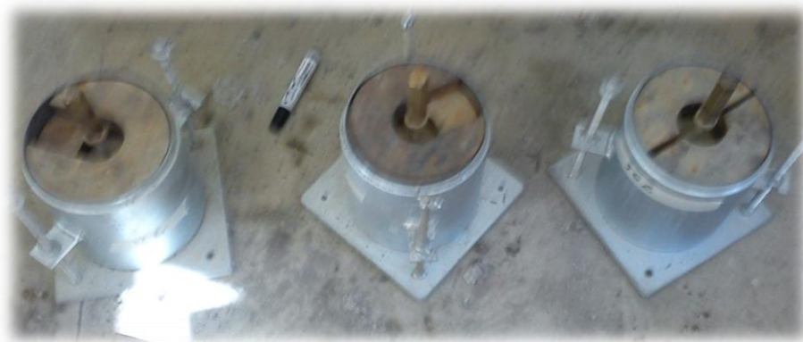
Imagen N°20, Lectura final de la expansion
