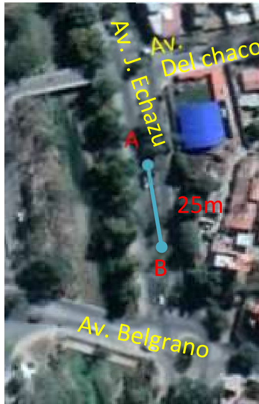
Imagen 14. Tramo Avda J. Echazú entre Avda Héroes del Chaco-Avda Belgrano Velocidad Percentil 85 = 35.40 km/h
