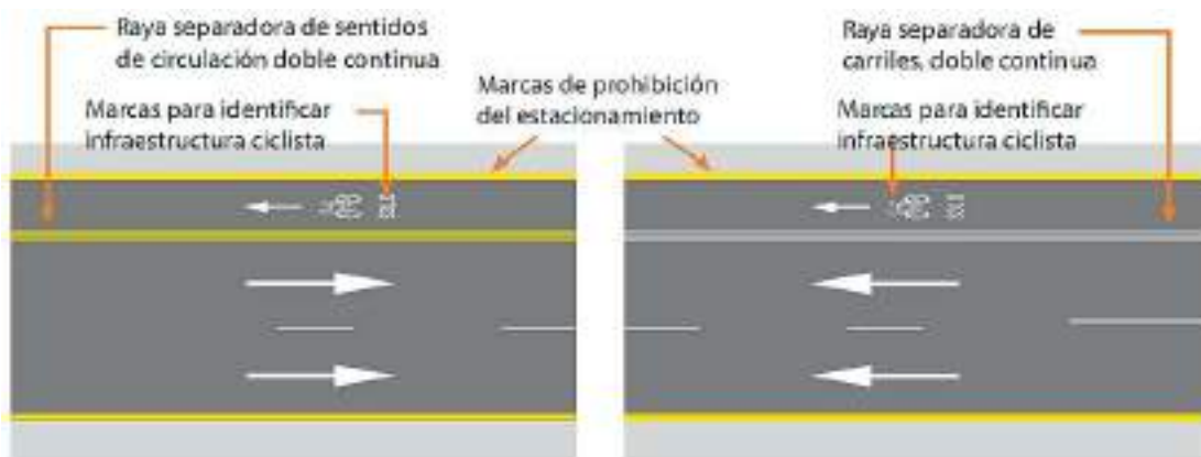
Figura 53. Demarcación para la separación de ciclovía carril exclusivo con calle.
