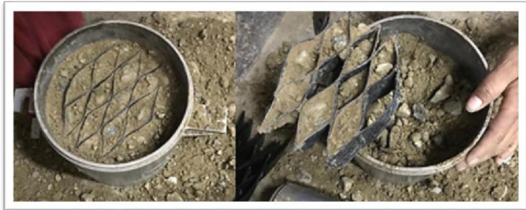
Figura 4.3. Resultado de aplicación de geoceldas + RAP en ensayo de compactación.
