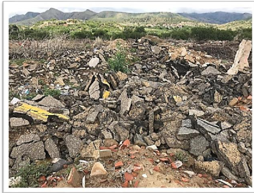
Figura 3.17. Grandes extensiones de pavimento asfáltico en desuso.
