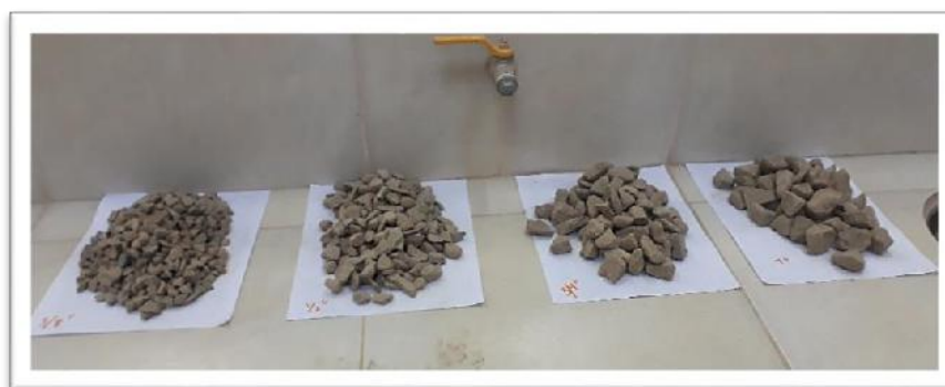
Figura 3.6. Preparación de muestras para ensayo desgaste de los Ángeles.
