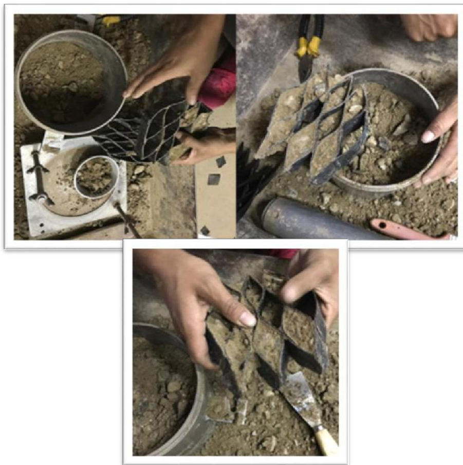
Figura 4.4. Extracción de muestras de las geoceldas. (Posterior al ensayo de compactación).
