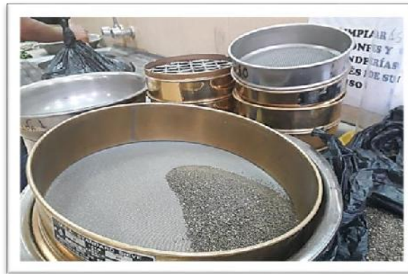
Figura 3.25. Empleo de tamices para la selección del RAP.
