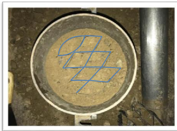
Figura 4.2. Aplicación de geoceldas en ensayo de compactación.
