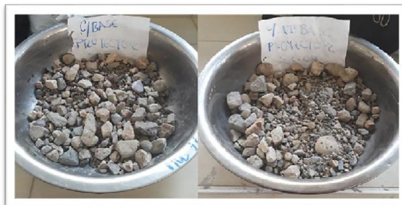
Figura 3.8. Material saliente del equipo de capa base y capa sub-base.
