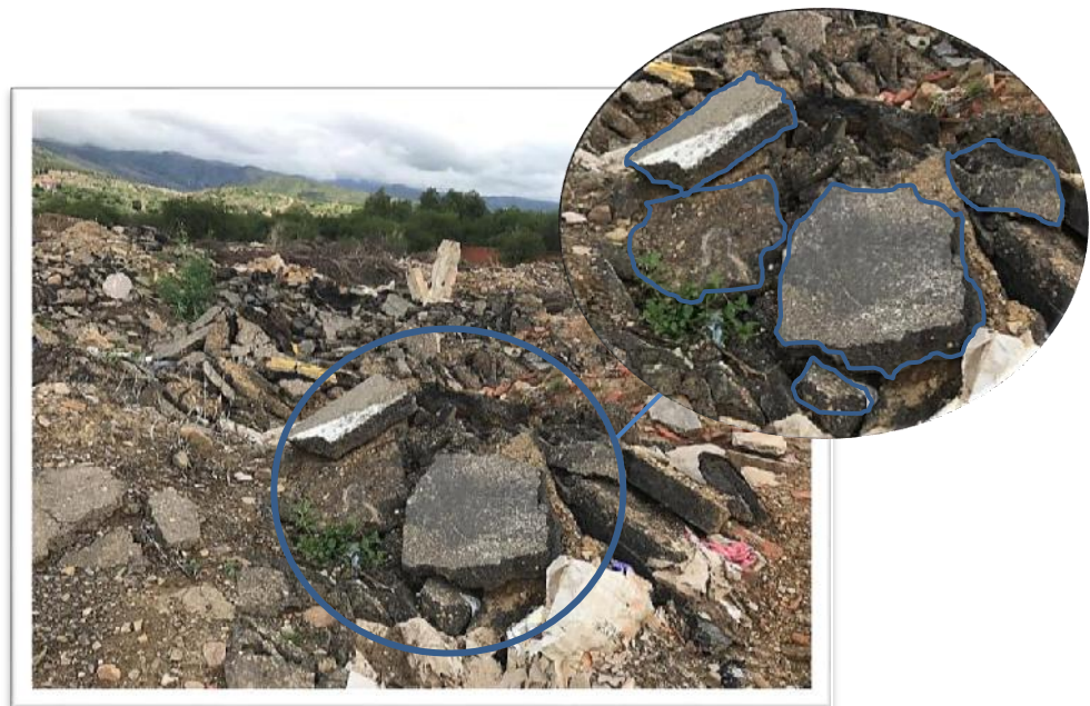
Figura 3.21. Pavimento asfáltico en dimensiones extensas en desuso.
