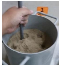
Figura 27 Varillado de agregado.
