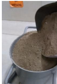
Figura 26 Rellenado de material fino en molde
