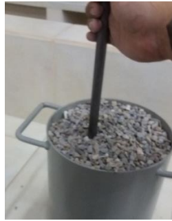
Figura 22 Varillado de agregado
