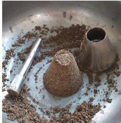
Figura 37 Ensayo para humedad superficial
