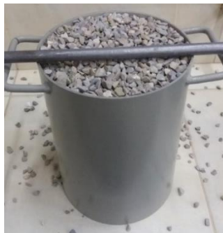
Figura 23 Nivelado de agregado grueso
