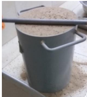
Figura 28 Nivelado de agregado grueso
