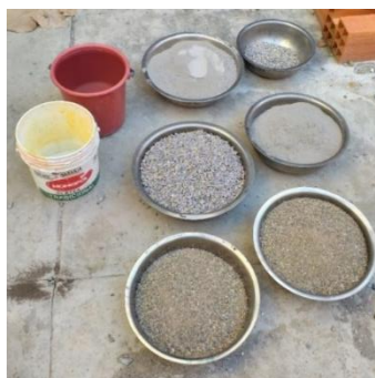
Figura 40 Agregados para el hormigón
