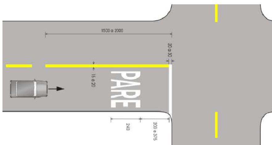
Figura 2-12 Señalización horizontal en cruce reglado con la señal de PARE
