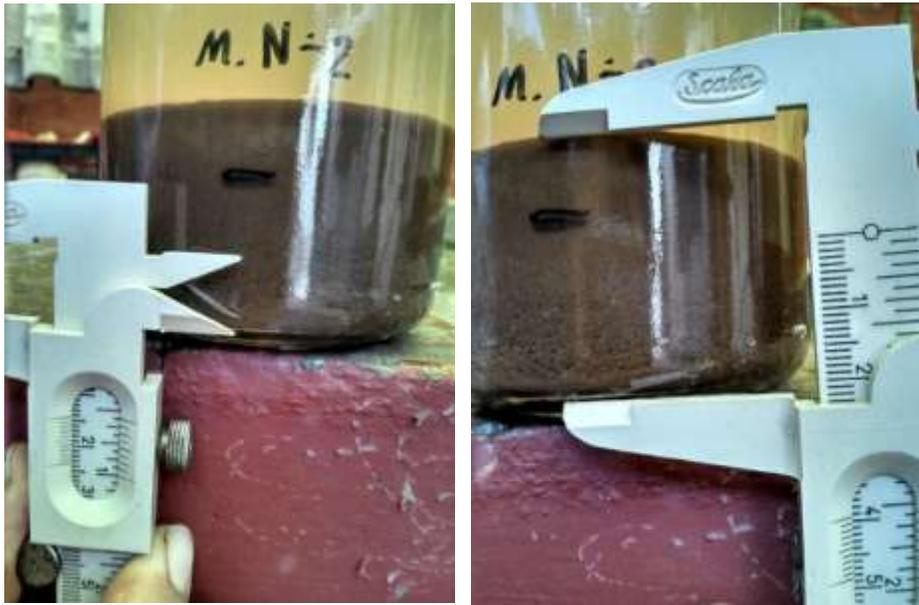
*Figura 68 y Figura 69 Mediciones de altura en muestra 2*
