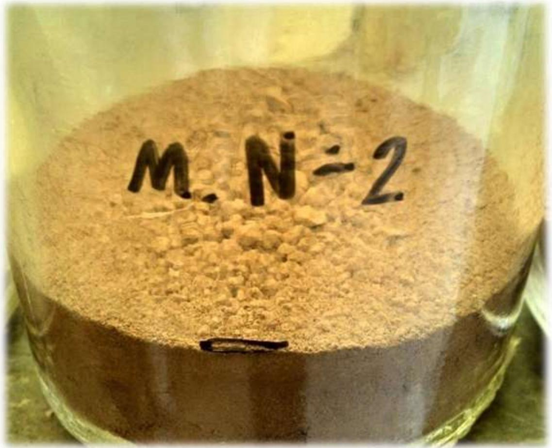
*Figura 62 Prueba de sedimentación, muestra 2*
