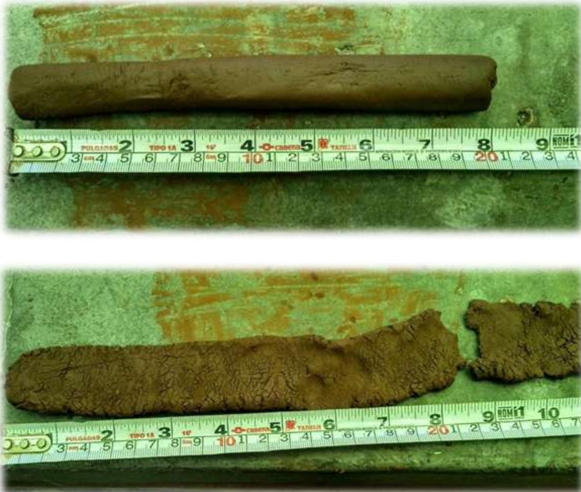
Figura 43 Formación de cordón y rompimiento de cinta en muestra 4
