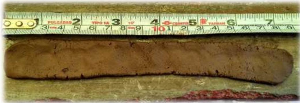
Figura 42 Formación de cordón y rompimiento de cinta en muestra 3
