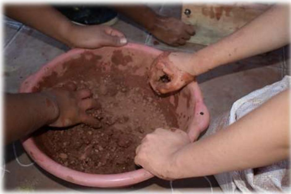
*Figura 35 Se evidencio las pruebas de laboratorio caseras, como: la prueba del cigarrillo, la pastilla, y la bolita; la cuales demuestran la dureza, la solidez, y la extracción al secarse, como vemos en las imágenes.*
