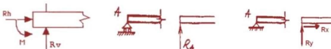
Figura 2.5. Tipos de apoyo móvil y fijo
