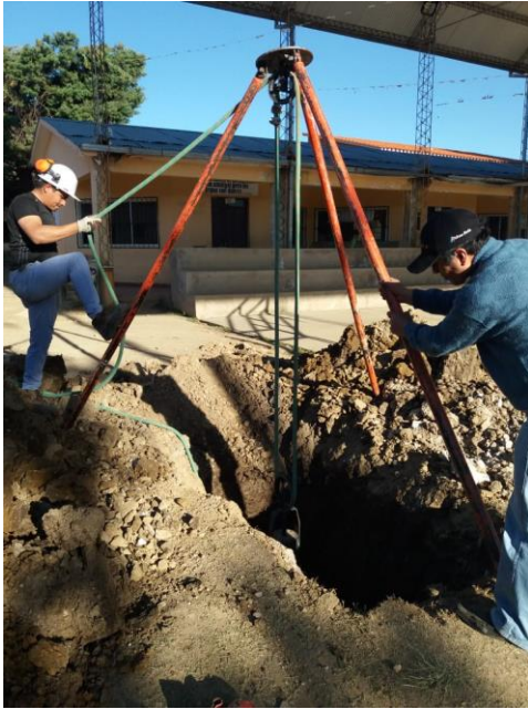
Figura 3.3. Ensayo SPT pozo N°1
