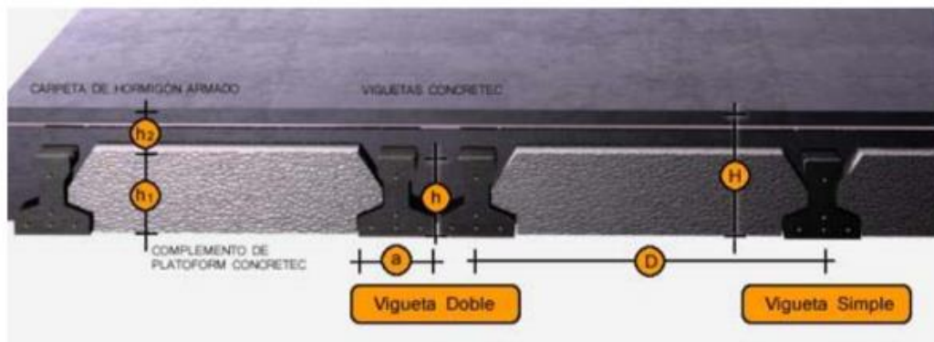
Figura 2.11. Sistema de aplicación de la vigueta
