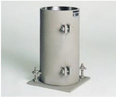
Figura 2.5 Molde cilíndrico para elaboración de probetas Controls UAJMS
