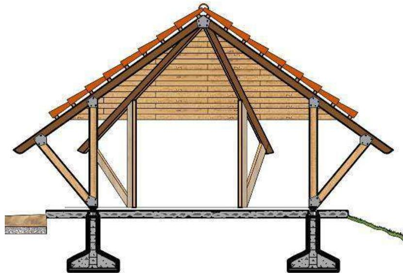
Cabe destacar que la hacienda específicamente la bodega sufrirá cambios en la parte superior netamente la cubierta, para ellos se reemplazara la estructura de hierro, por cerchas de madera en formas triangulares ancladas a las columnas que se mantendrán como puntos de apoyo y la cubierta será puesta con teja colonial.
