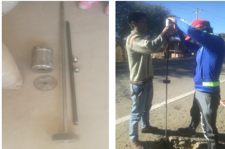
Figura 3. 5. Equipo de PDC y Realizando el levantamiento de datos para el PDC.
