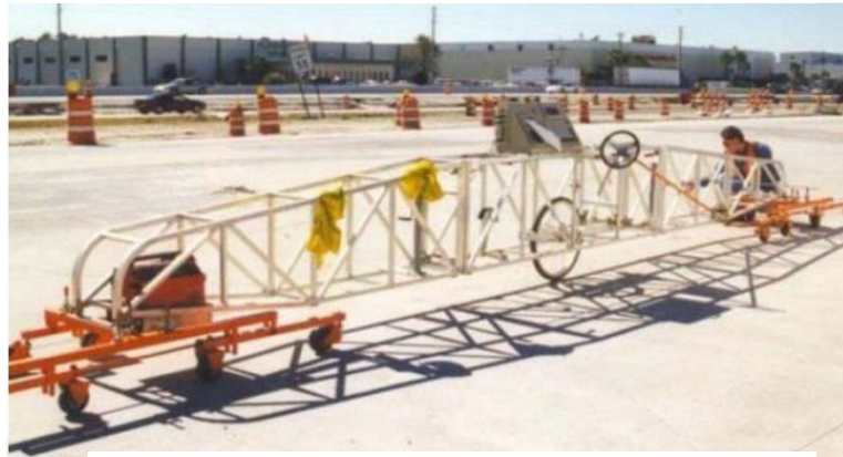
Figura 2. 11. Perfilómetro dinámico (Nava,2007)
