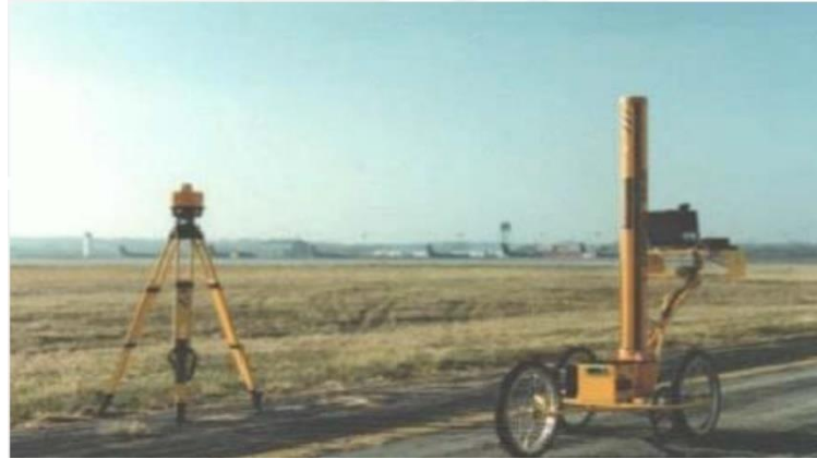
Figura 2. 9. sistema de datos con nivel y mira en pavimentos ( Nava,2007)
