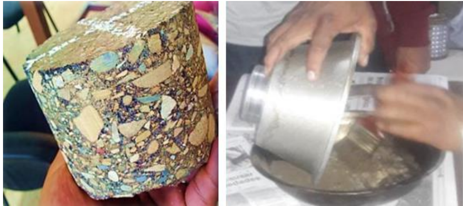
Figura 3. 4. Muestra progresiva 1+500 y proceso de separación de ligante y agregado.
