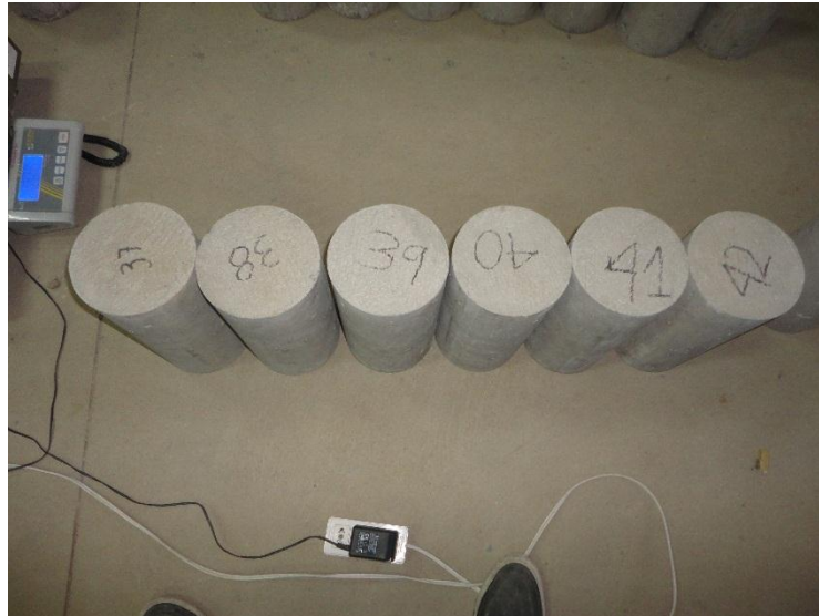
Figura 3.6.4 Probetas curadas por riego
