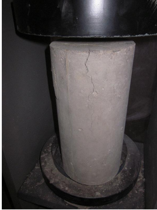
Figura 3.7.2 Probeta Rota en la Prensa
