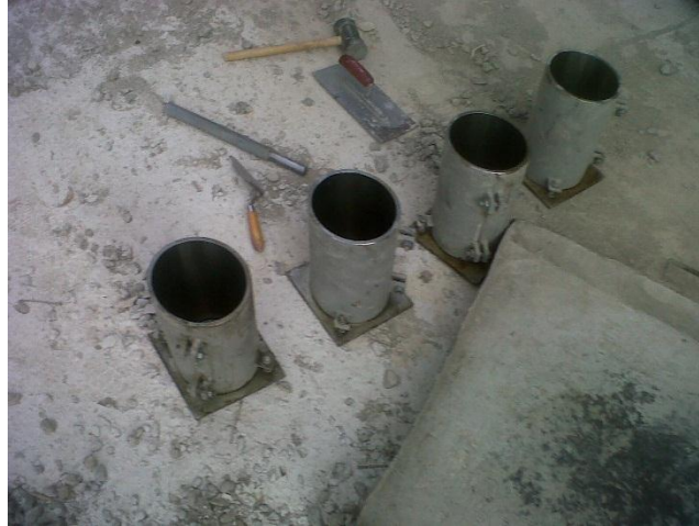
Figura 3.5.1 Probetas engrasadas listas para el vaciado
