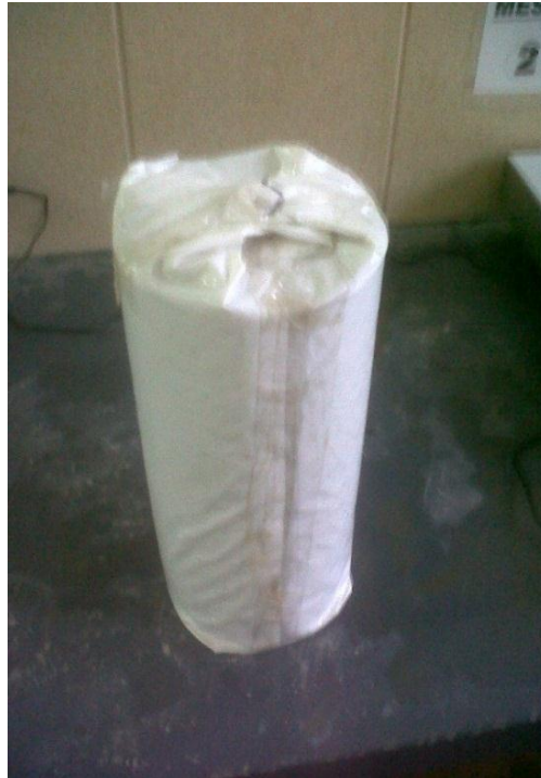
Figura 3.6.3 Probeta Forrada con Plástico Poliéster
