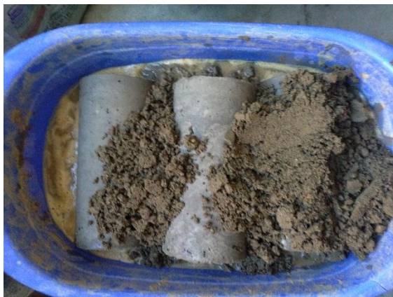
Figura 3.6.2 Probetas curadas con Arena Húmeda
