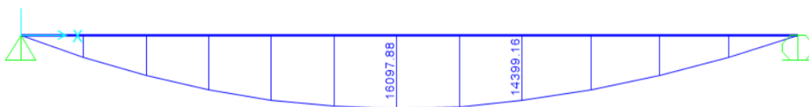
Figura 3.30 Diagrama de momento flector de la escalera
