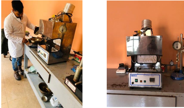
Figura 3.5 Ejecución de viscosidad Saybolt-Furol
