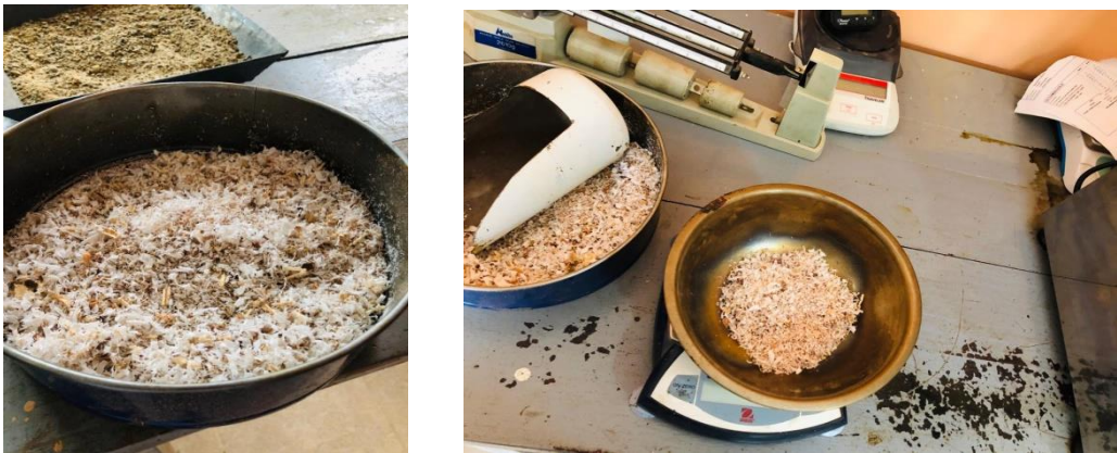
Figura 3.7 Polipropileno para la elaboración de la mezcla asfáltica
