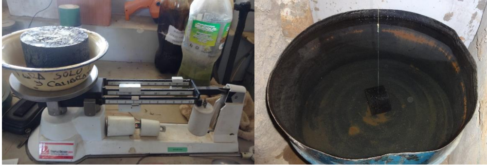
Figura 4.3 Pesado de briquetas en aire y sumergido
