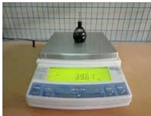
Figura 3.6 Ejecución del ensayo peso específico del ligante
