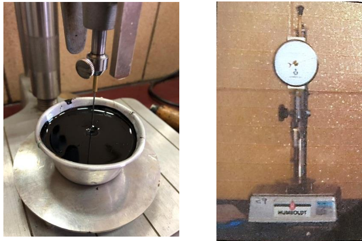
Figura 3.3 Realización del ensayo de penetración.
