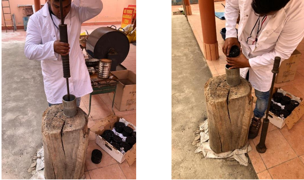
Figura 4.2 Preparación del molde y colocada de la mezcla
