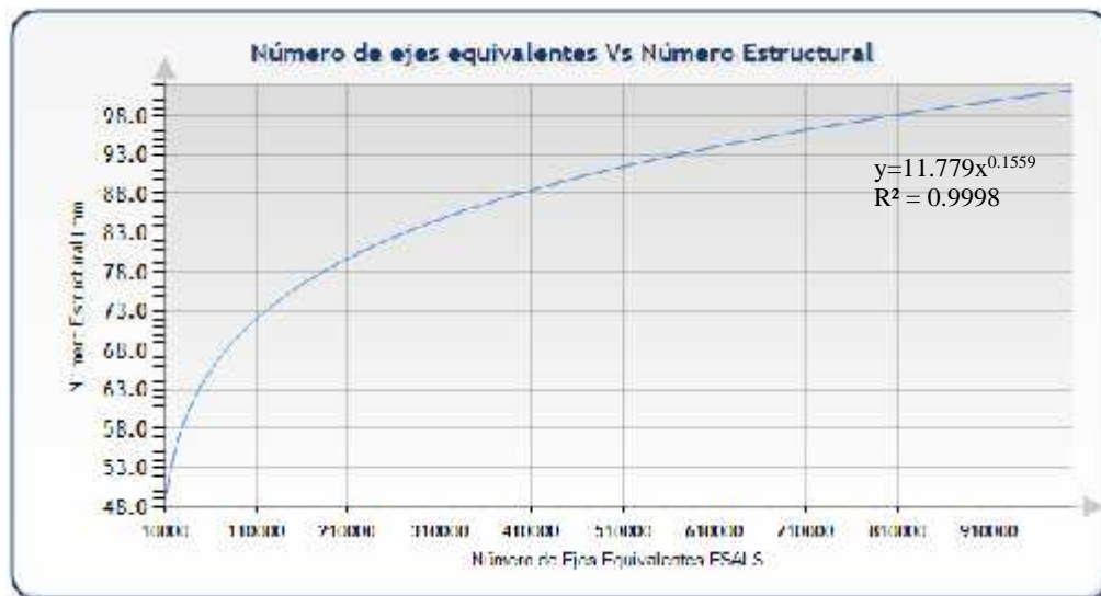
Figura 0.9 Número de ejes equivalente Vs Número estructural
