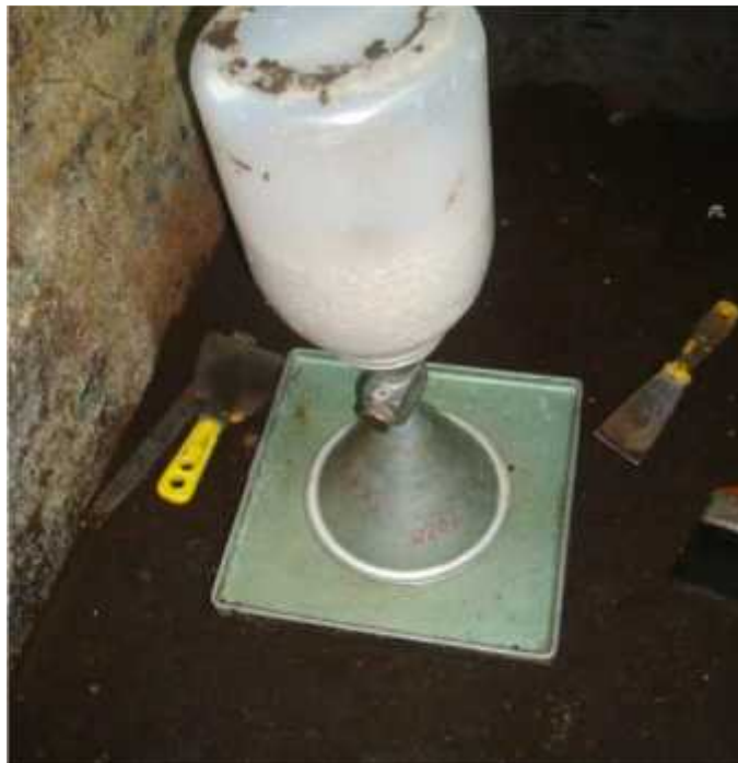
Fotografía 0.10 Toma de densidad en la caja
