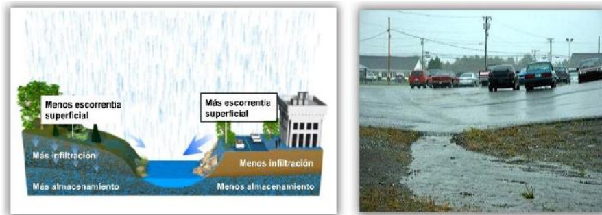
Figura N° 4: Áreas urbanizadas reduce la infiltración.
