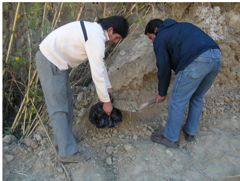
Recolección de muestra Pie del Talud
