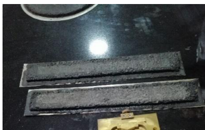
Figura 3.12. Muestra después del ensayo rueda cargada LWT.
