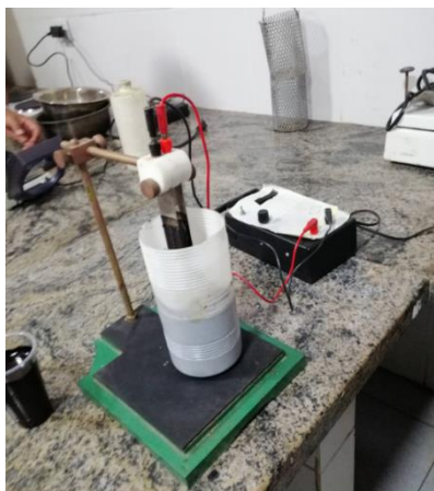
Figura 3.8. Ensayo carga eléctrica de la emulsión asfáltica.
