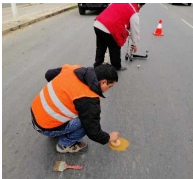
Figura 4.6. Evaluación de macro textura con el ensayo círculo de arena.
