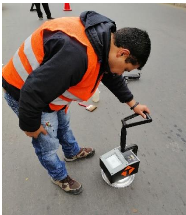
Figura 4.4. Uso del equipo densímetro no nuclear PQI 380.
