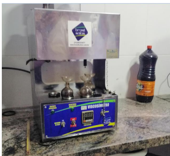
Figura 3.7. Viscosidad Saybolt de la emulsión asfáltica.
