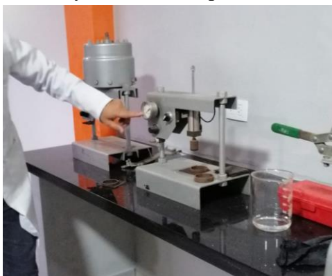
Figura 3.11. Ensayo de abrasión por vía húmeda WTAT.
