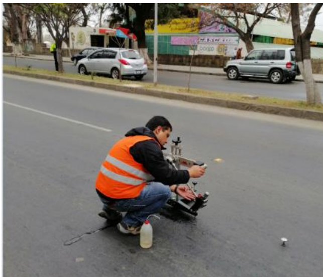
Figura 4.5. Evaluación de micro textura con el péndulo británico.
