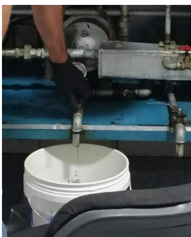
Figura 3.9. Ensayo residuo por evaporación.
