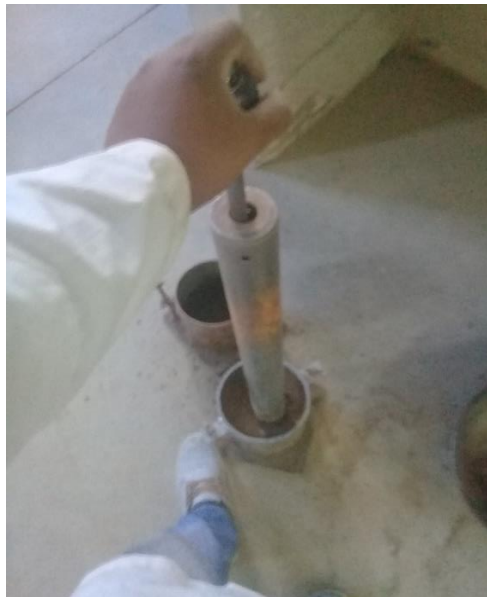
Figura N°3.9: Proceso de compactación.
