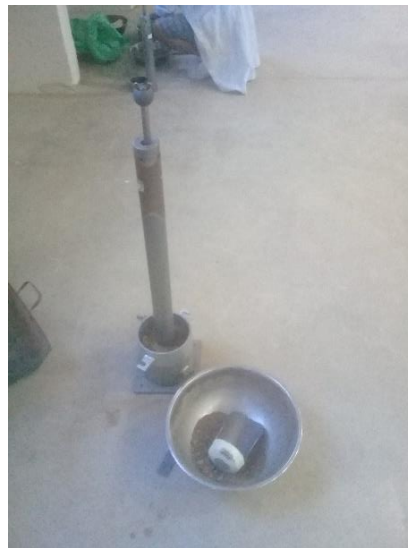
Figura N°4.8: Compactación del material granular con cemento.
