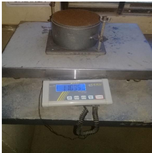
Figura N°4.3: Suelo granular compactado.
