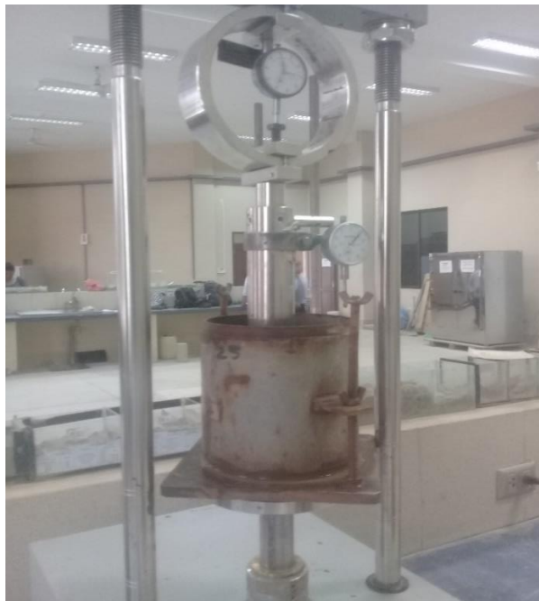
Figura N°3.13: Prueba de penetración.
