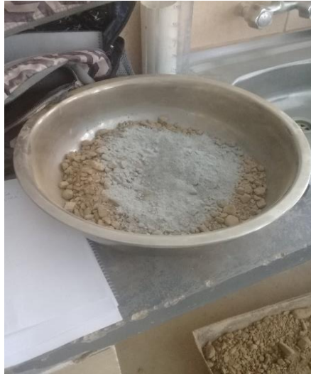
Figura N°4.7: Material granular con cemento.
