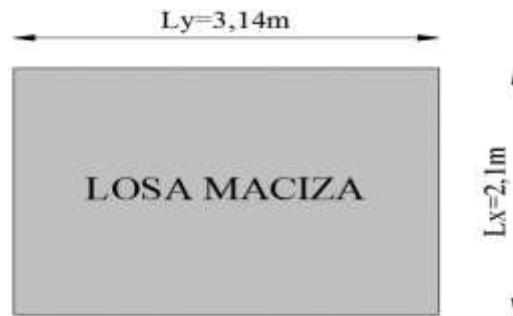
Figura 3. 9 Dimensiones de la losa maciza.
