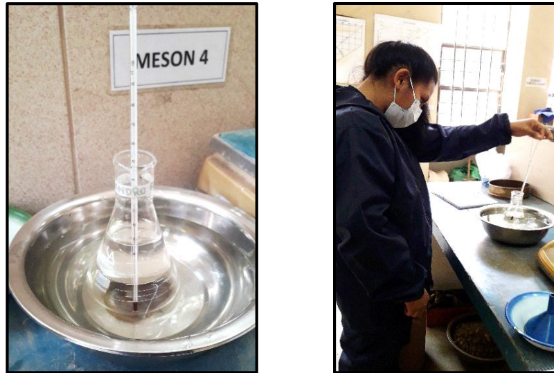
Figura 26. Calibración del picnómetro
