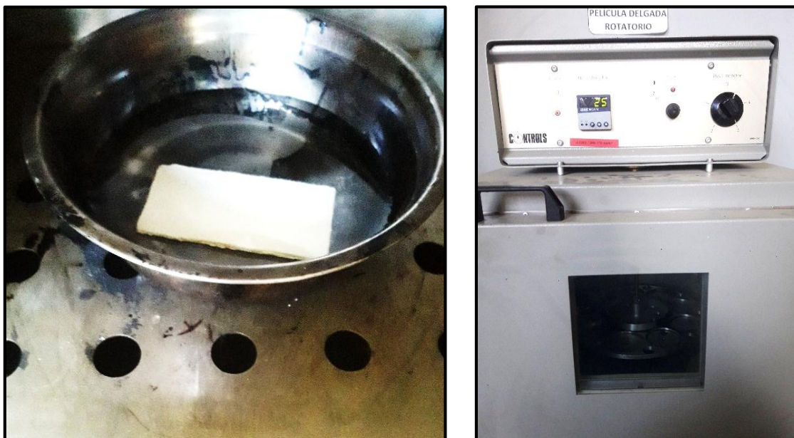
Figura 46 Proceso de sumersión en agua destilada a 25 °C
