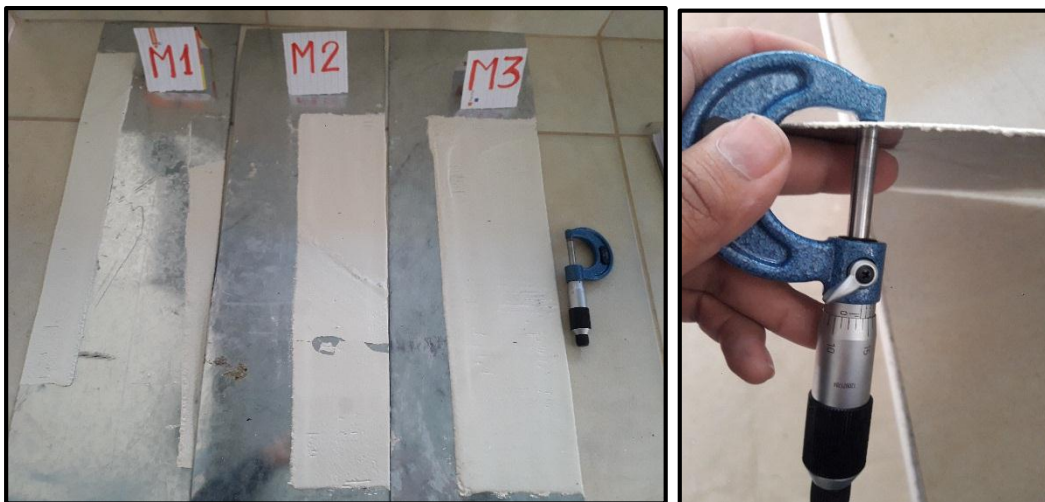
Figura 71. Medición de espesores a las muestras extraídas
