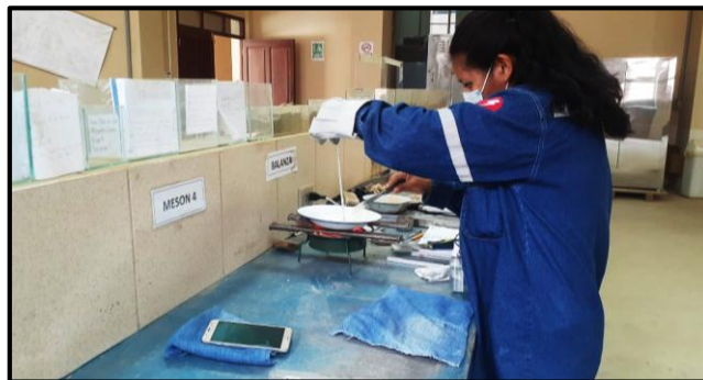
Figura 29. Proceso de calentamiento del termoplástico
