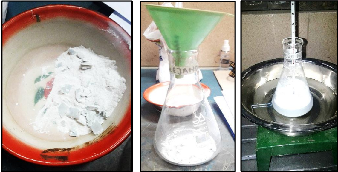
Figura 28. Muestra de 80gr de termoplástico antes de someterlo a baño maría
