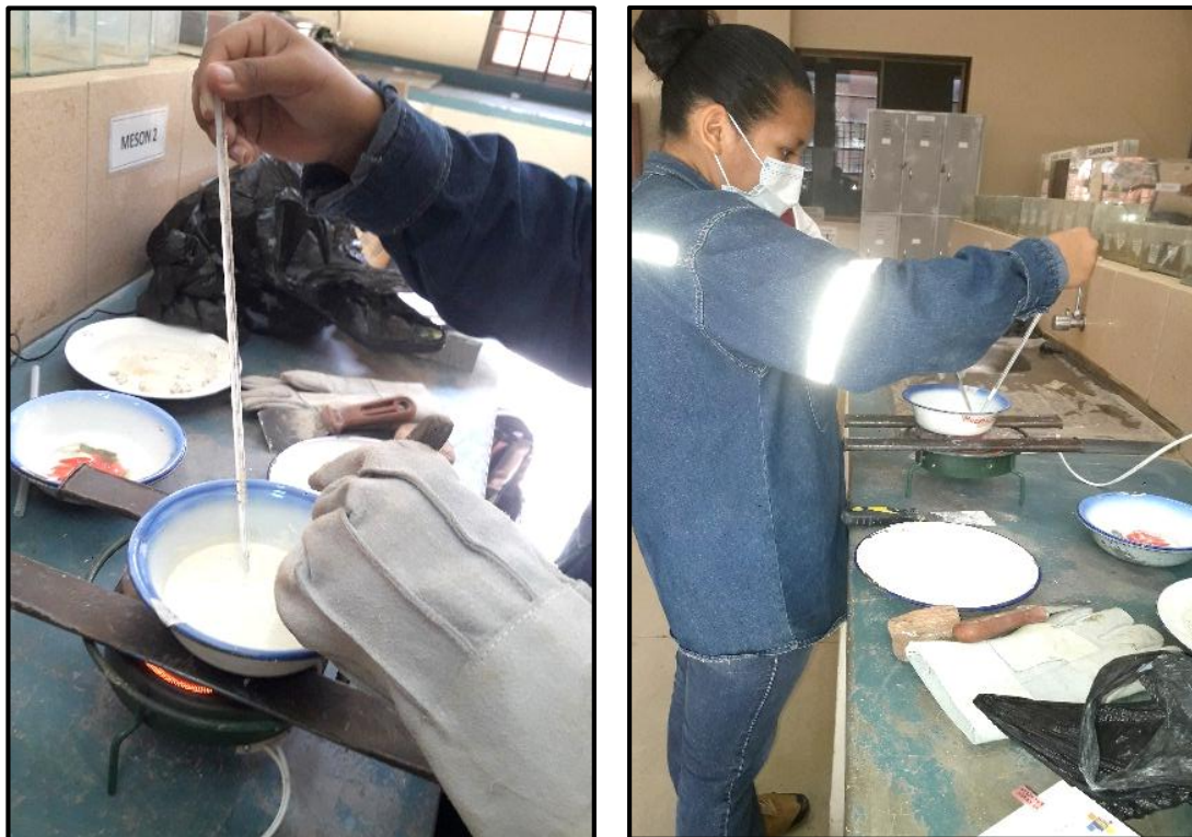
Figura 36. Proceso de calentamiento del termoplástico
