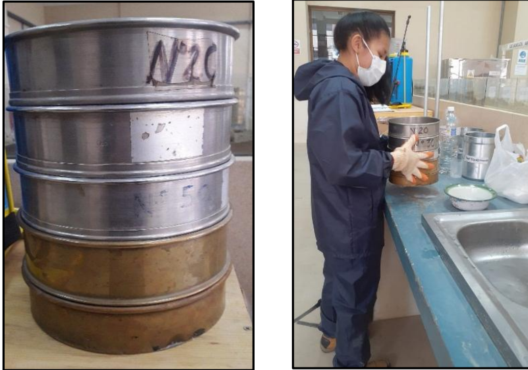
Figura 25. Tamizado de las microesferas de vidrio
