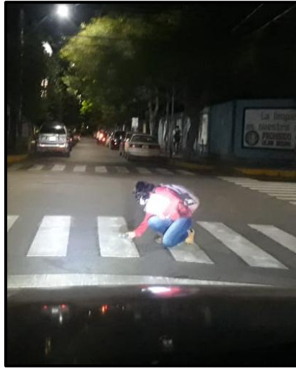
Figura 77. Medición de la intensidad de la luz con el luxómetro
