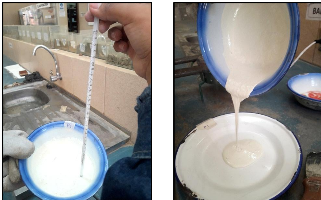
Figura 37. Control de temperatura para el vaciado
