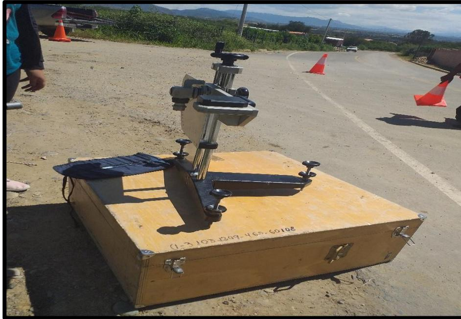
**Imagen 29: Calibración del equipo del Péndulo Británico**
