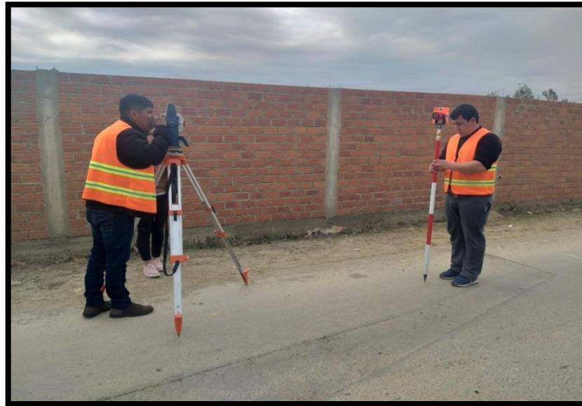
Figura N° 31: Estimación de los puntos específicos cada metro aproximadamente con la ayuda del prisma
