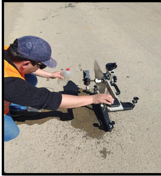
Figura N° 22: Ejecución del ensayo del péndulo de fricción británico
