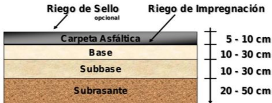
Figura N° 1: Sección transversal de una vía
