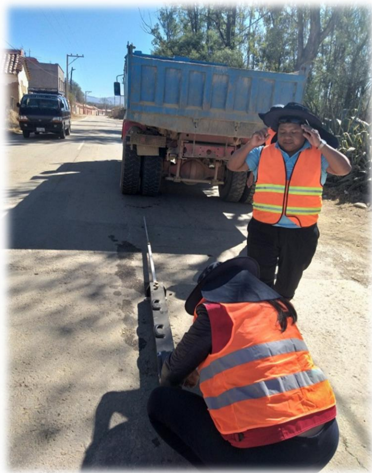
Figura N° 47: Última lectura del dial deformación cero
