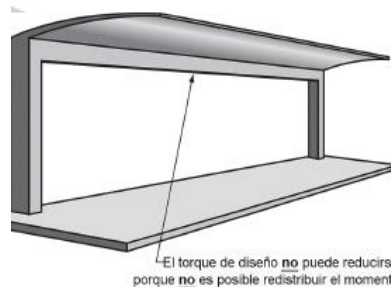
Figura 3.8.5-1 a). El torque de diseño no puede ser reducido. (Comite ACI 318, 2014)
