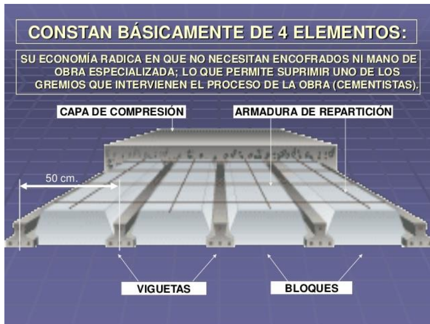
Figura 4.8. Parámetros de una losa alivianada con viguetas pretensadas.
