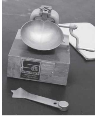
Figura 2.5: Aparato de Casagrande Fuente: Fundamentos de Ingeniería Geotécnica
