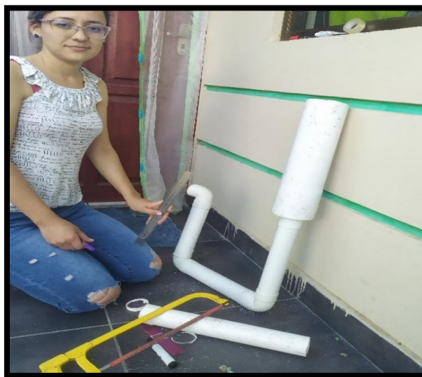
Ilustración 26 Elaboración de permeámetro de carga constante. Fuente: Elaboración propia
