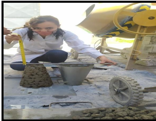
Ilustración 18 Medición del asentamiento. Fuente: Elaboración propia
