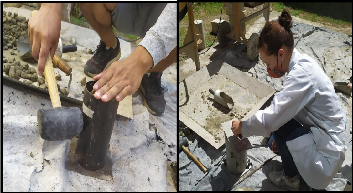
Ilustración 20 Relleno y compactado de probetas. Fuente: Elaboración propia
