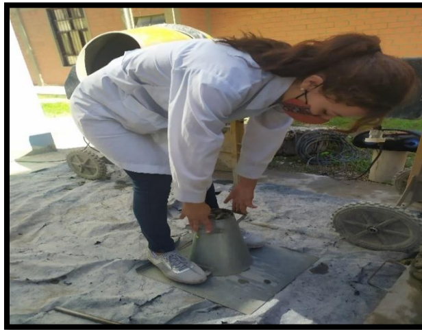
Ilustración 18 Medición del asentamiento. Fuente: Elaboración propia
