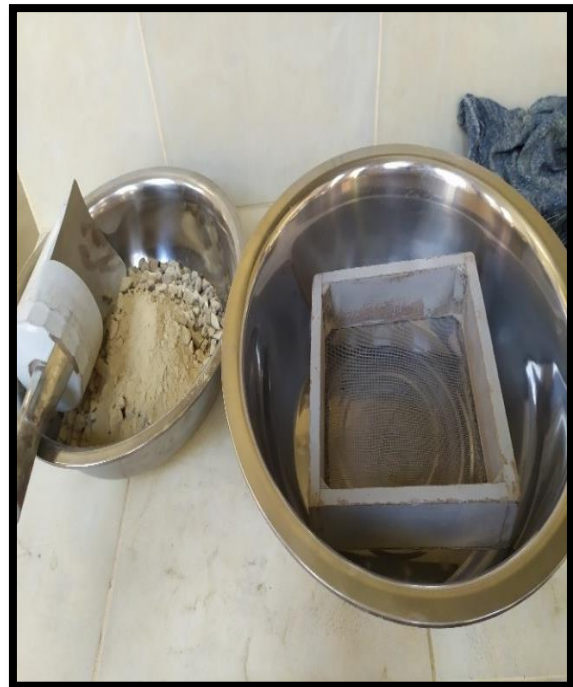
Ilustración 15 Tamizado de muestra triturada
