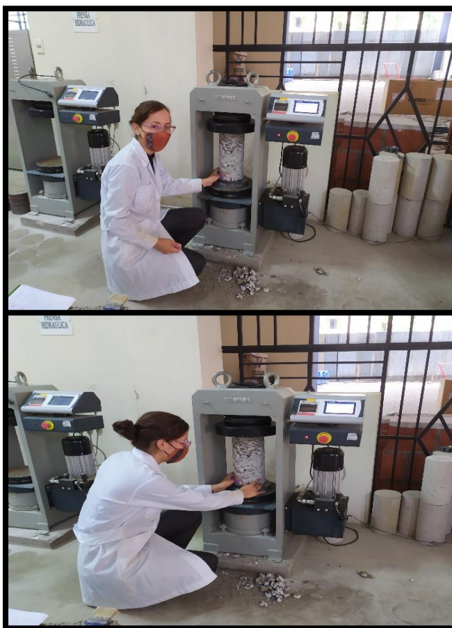
Ilustración 24 Proceso de rotura. Fuente: Elaboración propia
