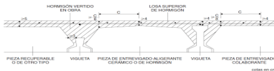
Figura 2. 6 Forjado unidireccional de viguetas pretensadas.
