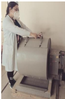
Figura 14: Máquina del desgaste de los Ángeles
