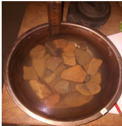
Figura 13: Ensayo con sulfato de magnesio
