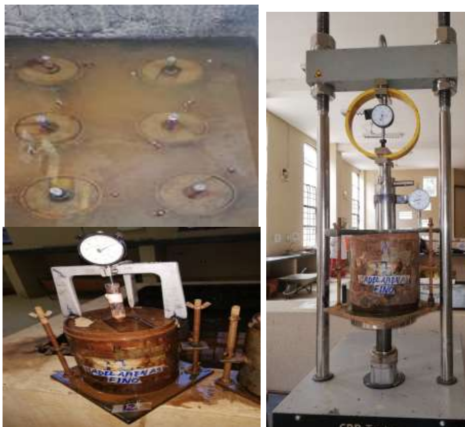
Figura N° 3.11. Proceso de inmersión y penetración del ensayo de C.B.R.
