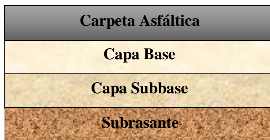
Figura N°2.1. Estructural de un Pavimento Flexible
