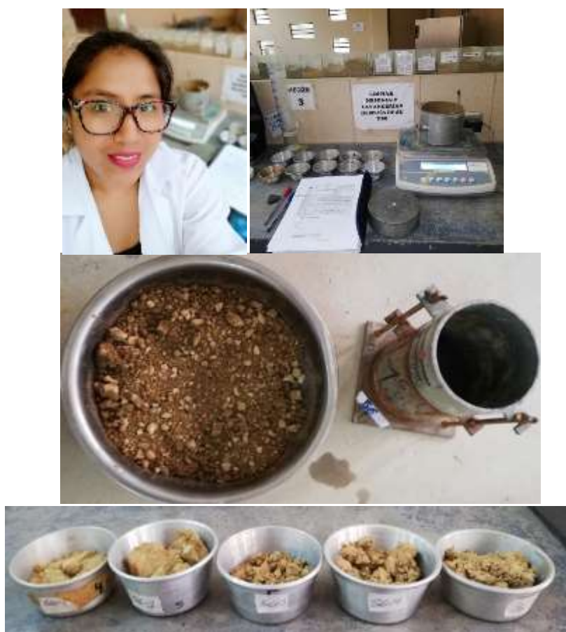
Figura N° 3.13. Ensayo de compactación.
