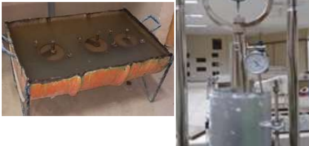
Figura N° 3.14. Proceso de inmersión y penetración del ensayo de C.B.R.
